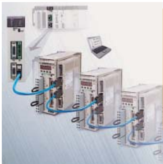
Una serie di inverter Sysdrive 3G3MV con la scheda PLC 3G3MV-P10CDT fornisce il controllo distribuito sull'intera linea. La combinazione PLC + inverter consente di esercitare un controllo preciso su tutti i processi lungo la linea di trasferimento. Inoltre, grazie alla modularità della scheda, il sistema può crescere in maniera flessibile, in base alle esigenze del movimento.
