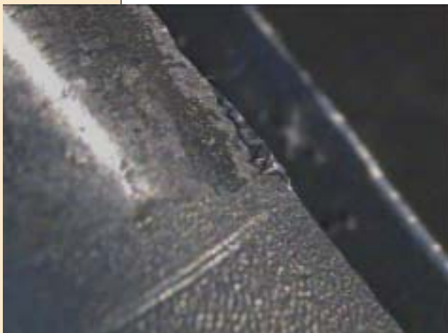
Figura 4 Il lato sinistro dello spigolo è stato protetto dal getto di sabbatura e quindi è ancora con la bava, il lato destro è stato efficacemente sbavato.
