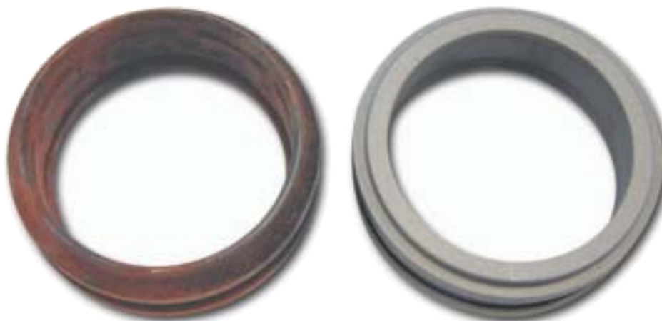
Figura 1 Particolare a sinistra, dopo tempra, a destra, dopo sabbatura a corindone.
