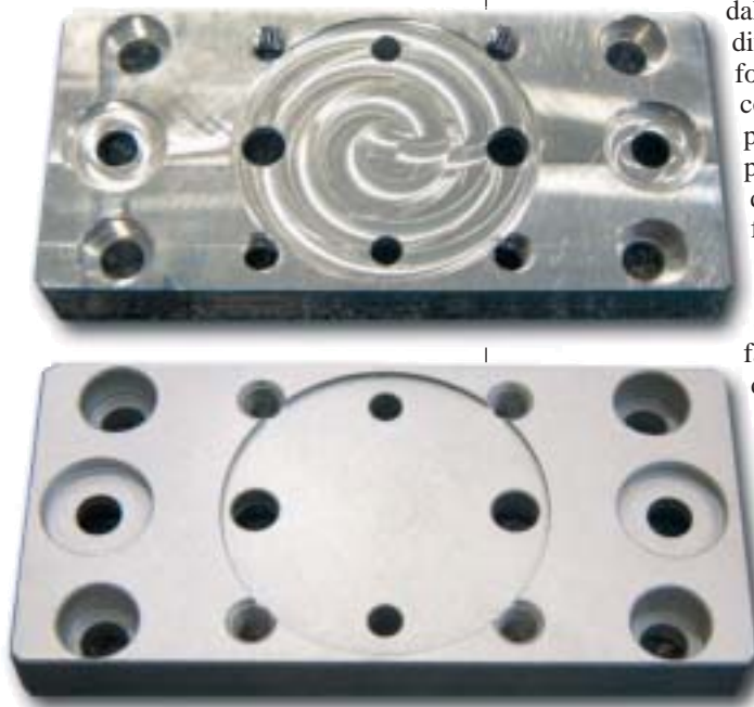
Figura 2 Particolare in alluminio: sopra sono evidenti i segni di lavorazione, sotto, il particolare dopo sabbiatura.
