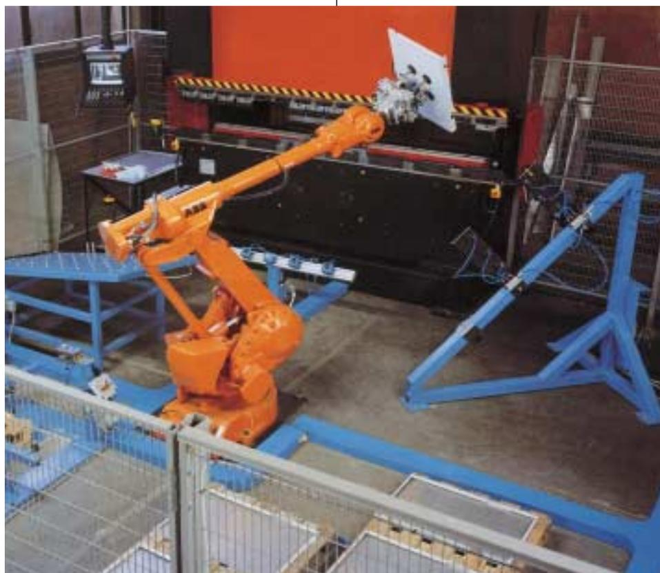
**Soluzione per l'asservimento robotizzato di macchine pressopiegatrici proposta da ABB.**
