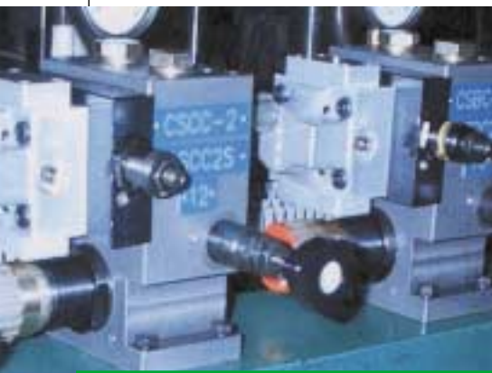
Bloccchi idraulici di sicurezza Moog.
