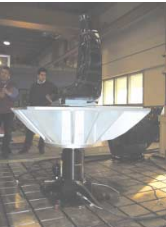
Un esempio di shaker per vibrazione verticale Moog.
