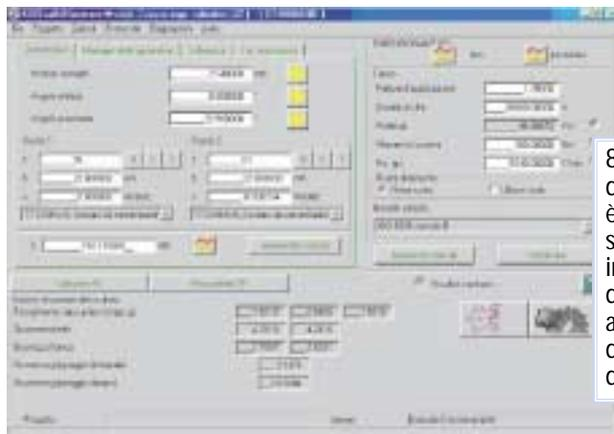
8. Interfaccia grafica del codice KISSsoft: è mostrata la schermata di inserimento dati della geometria, a sinistra, e il grafico della temperatura di "Flash" a destra.
