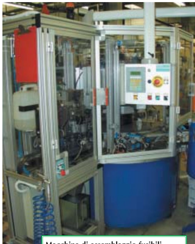
Macchina di assemblaggio fusibili Midival della MTA, dove i componenti Festo sono utilizzati per tutto l'impianto pneumatico.
