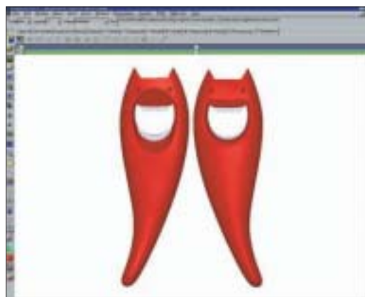
Superfici CAD delle due facce dell'apribottiglie Diabolix.
