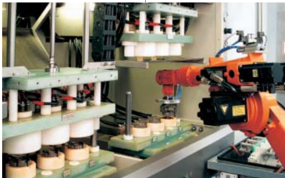
Figura 1 Impianto di sbavatura automatico ECM con due stazioni di lavorazione e robot industriale
