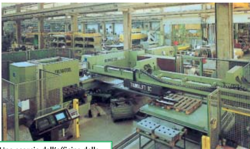
Uno scorcio dell'officina della Comarme. In primo piano un impianto automatizzato per la lavorazione della lamiera.
