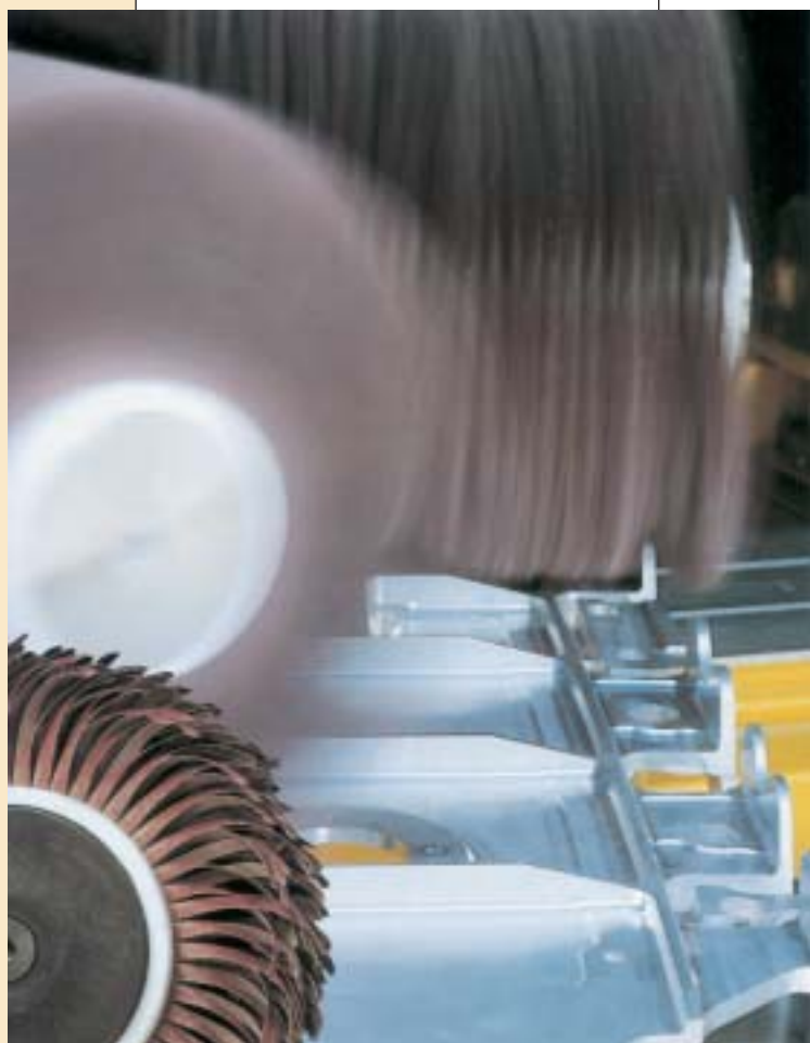
Particolare della sbavatura di un pezzo metallico.
