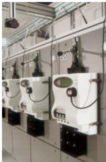
**I contatori sul banco di quality assurance dove vengono certificati i lotti tramite un test in percentuale che va eseguito a campione.**
