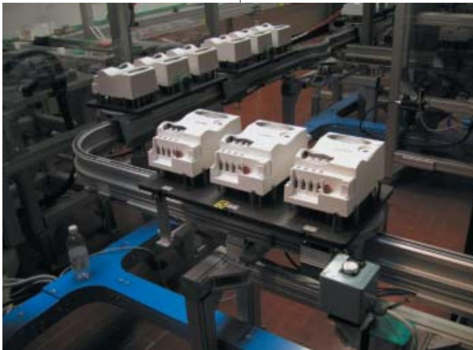
Un particolare dell'isola di finitura ci permette di vedere il Montrac, la soluzione di Montech impiegata per la movimentazione dei contattori.
