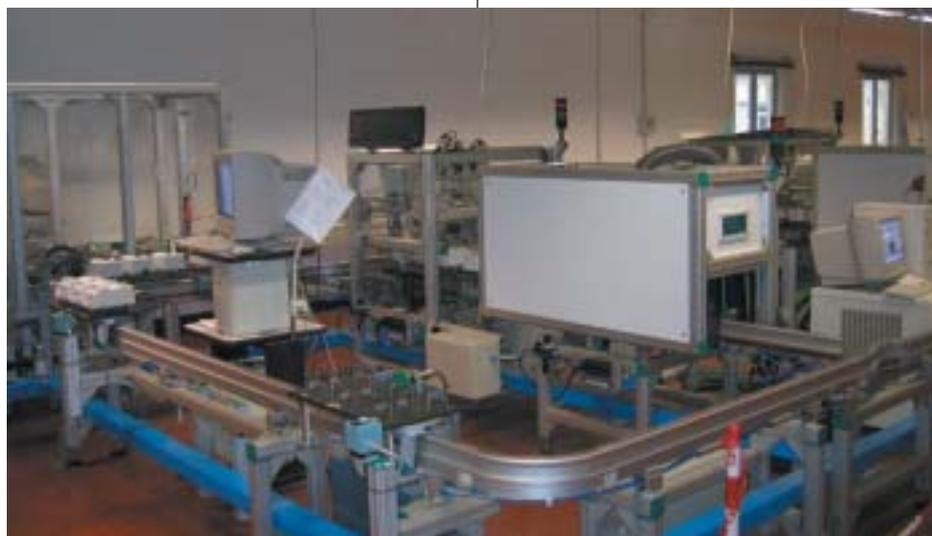
preleva e scarica i contatori tre alla volta. L'eventuale contatore di scarto che non ha superato tutta la fase di calibrazione viene scaricato su un nastro secondario in modo da essere gestito a parte da un operatore. L'algoritmo per la gestione dei buoni/scarti è stato sviluppato completamente da El.Ma..
