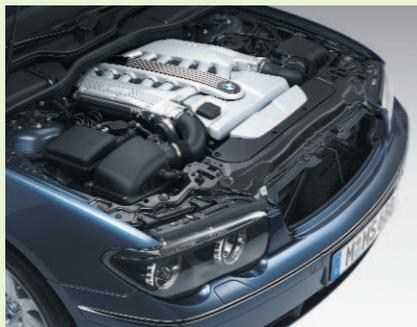
combustione. La pressione a tal fine necessaria viene generata da due pompe d'iniezione, una per bancata cilindri.
