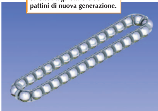
3. Gabbia guidasfere dei pattini di nuova generazione.
