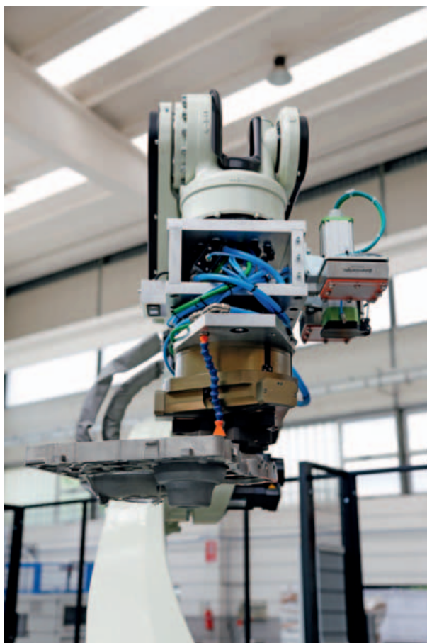
A bordo del gruppo pinza del robot BX200 è stata posizionata una telecamera gestita dal sistema di visione Tiesse Vision. L'elettromandrino è corredato di prelievo automatico dell'utensile.
