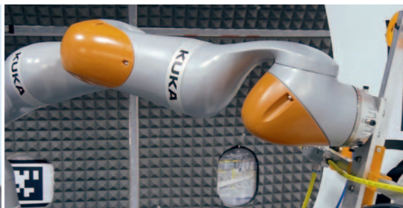
Un robot collaborativo su piattaforma mobile può alleviare l'operatore nella realizzazione di un lavoro fisico faticoso, ad esempio per assisterlo nel montaggio dei pannelli laterali o delle cappelliere.
