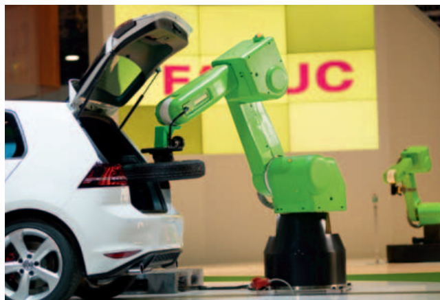
Un robot collaborativo CR-35iA, con payload da 35 kg, mentre movimentava una ruota da una automobile e il particolare della guida manuale.
