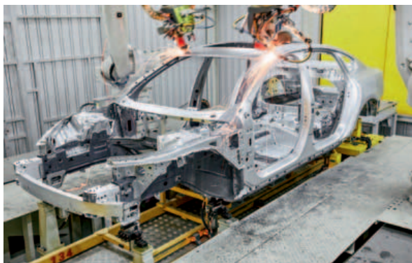
Le applicazioni fornite a Volvo da ABB Robotics comprendono anche movimentazione, saldatura a punti, rivettatura autoperforante, saldatura laser ed erogazione. Foto: Hans Nordlander.
