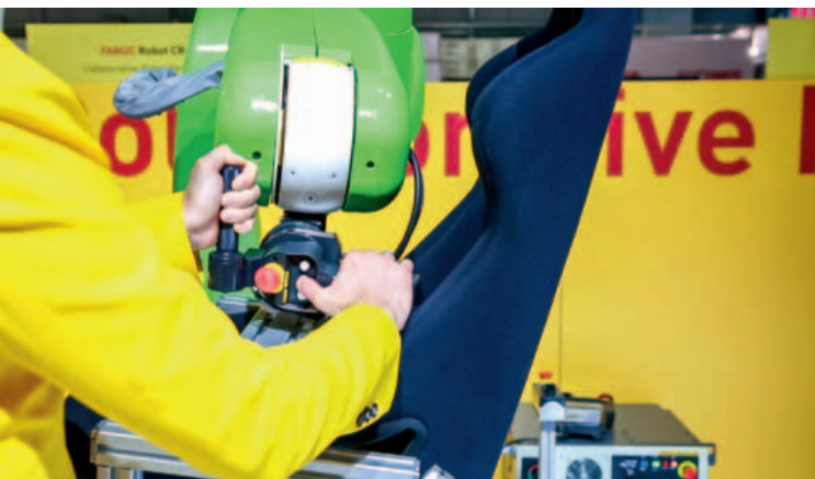
Un robot collaborativo CR-35iA, con payload da 35 kg, mentre movimentava una ruota da una automobile e il particolare della guida manuale.
