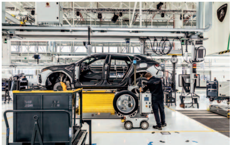
A sinistra, i carrelli AGV che servono a spostare le auto da una stazione all'altra. A destra, un 'cobot', su carrellino, porta una ruota al montaggio.
