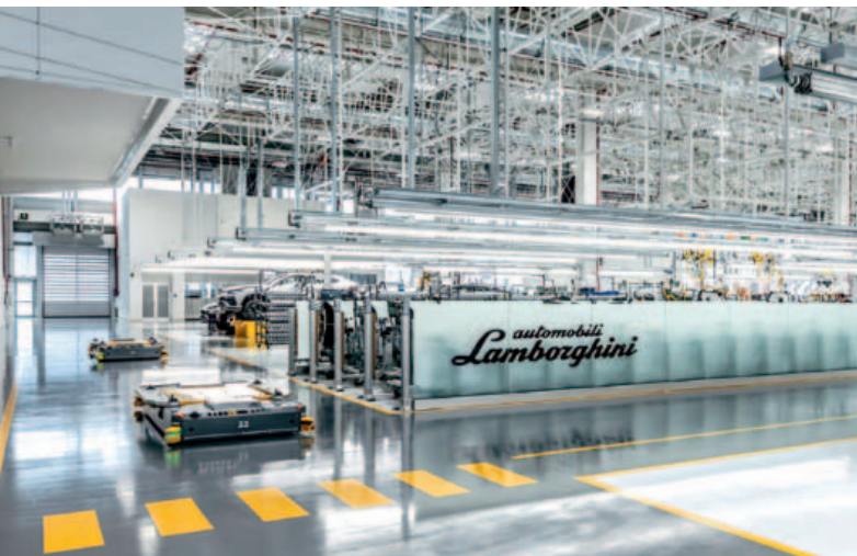
A sinistra, i carrelli AGV che servono a spostare le auto da una stazione all'altra. A destra, un 'cobot', su carrellino, porta una ruota al montaggio.
