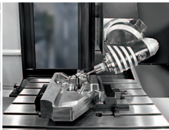
Il centro di fresatura Soraluce TA-A 35 incorpora tecnologie avanzate, come il controllo adattivo e la modalità 'sleep mode'.
