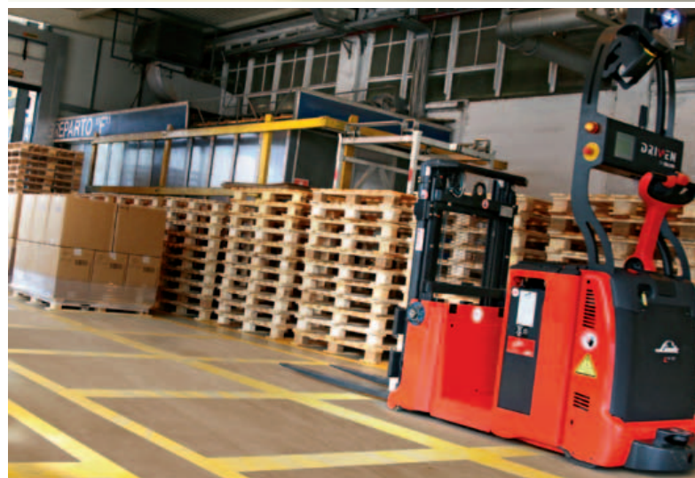
I carrelli Linde Robotics sono equipaggiati con una serie di laser, anteriori e posteriori, che assicurano operazioni sicure ed efficaci.
