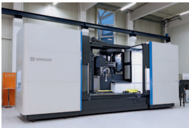
Il centro di fresatura Soraluce TA-A 35 incorpora tecnologie avanzate, come il controllo adattivo e la modalità 'sleep mode'.
