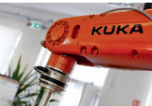
Optoforce ha sviluppato tre nuove applicazioni per robot Kuka, che impiegano i sensori multiassiali di forza e coppia prodotti dall'azienda. Nello specifico, le applicazioni consistono in guida della mano, per consentire ai robot Kuka di muoversi in modo
