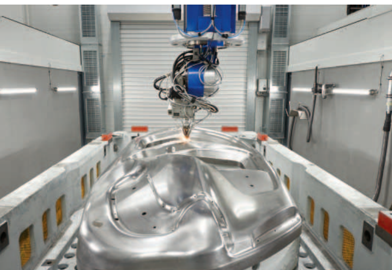
Operazione di cladding con macchina Laser Speeder.
