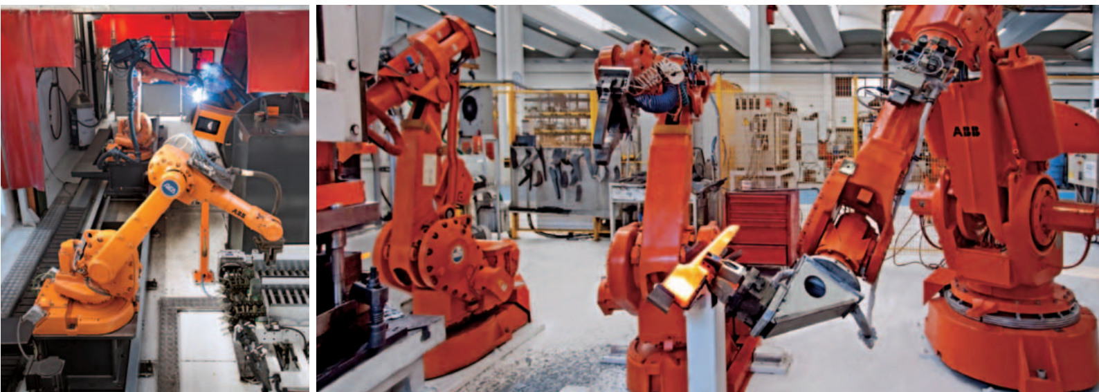
Maschio Gaspardo ha introdotto i primi robot negli anni Novanta per standardizzare il processo di saldatura mantenendo costante il livello qualitativo.
