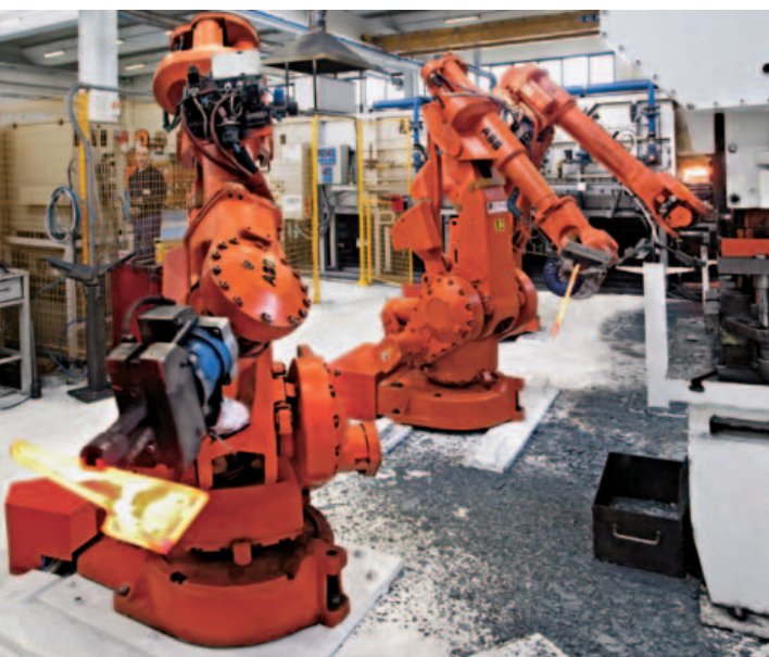
Maschio Gaspardo ha esteso l'utilizzo dei robot ABB anche all'asservimento di macchine a controllo numerico e alle presse.
