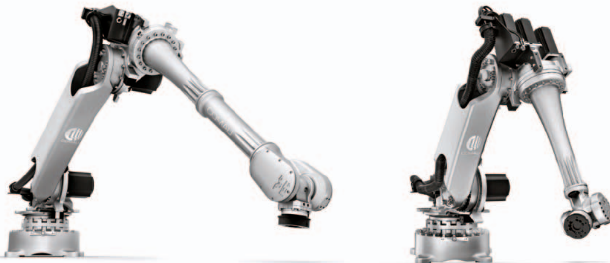
A sinistra, Comau Smart NJ 16, impiegato da Elettrosystem per l'assemblaggio teste cilindri e schede elettroniche; a destra, Comau NJ 60, robot dalla portata al polso di media entità, adatto per lavorazioni meccaniche.
