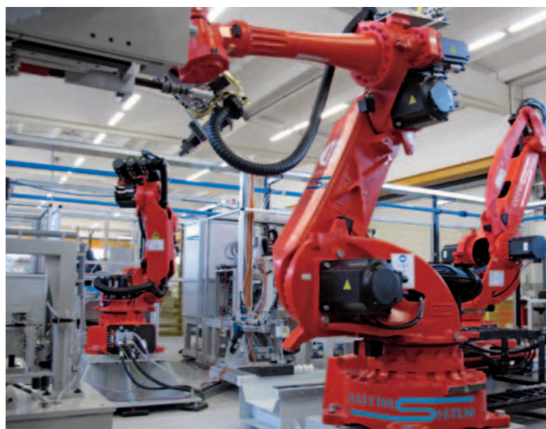
Elettrosystem: i robot presenti nella cella svolgono operazioni di trasferimento teste tra aree di lavoro e manipolazione di componenti.
