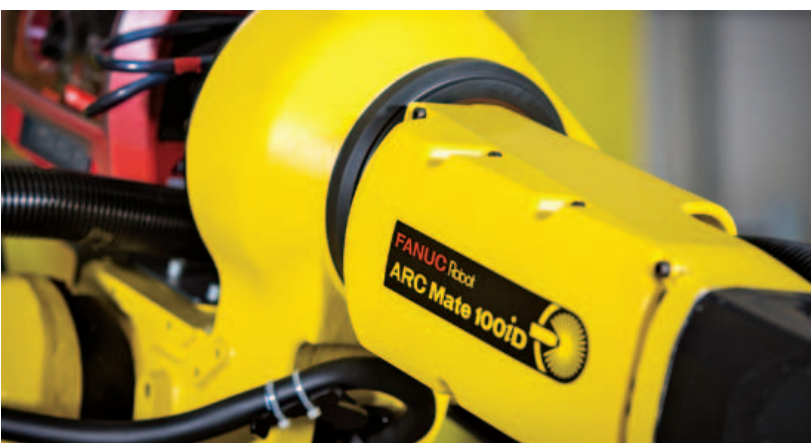
I robot Fanuc per la saldatura ad arco si distinguono per l'estrema compattezza. Il polso cavo consente completa libertà di movimento.
