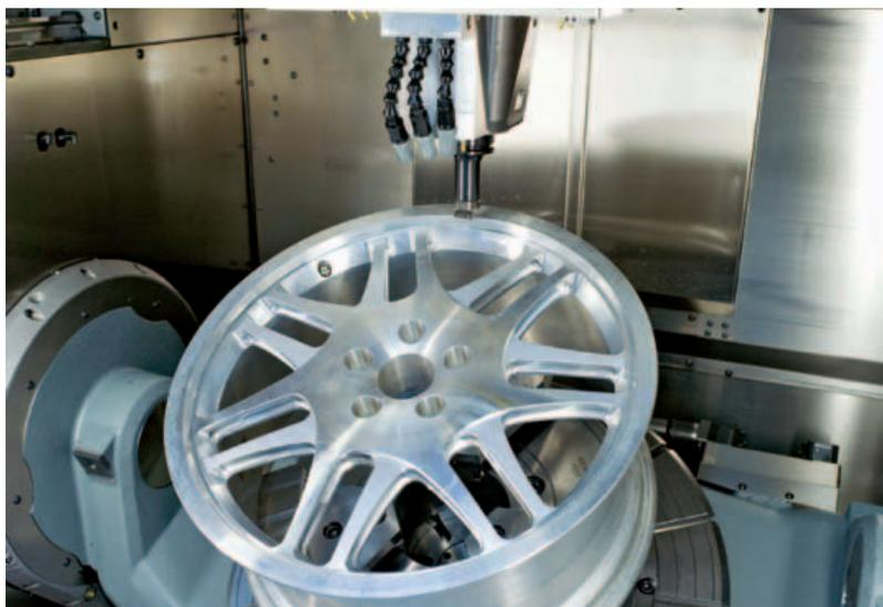
I sistemi di tastatura pezzo Heidenhain contribuiscono a ridurre i costi in officina e per le produzioni in serie. Su un centro di fresatura/tornitura con TNC 640 è possibile lavorare completamente il pezzo in un unico piazzamento.
