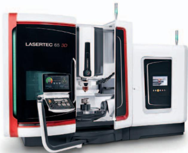
Con Lasertec 65 3D, DMG Mori ha integrato il processo di produzione laser generativo in una fresatrice a 5 assi.
