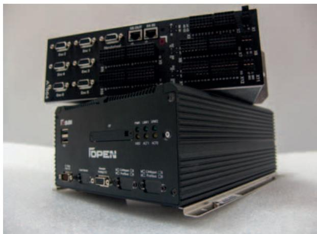
Osai ha fornito a BTB Transfer un Cnc Open-XL, alcuni moduli Bridge e un monitor touch-screen da 17".
