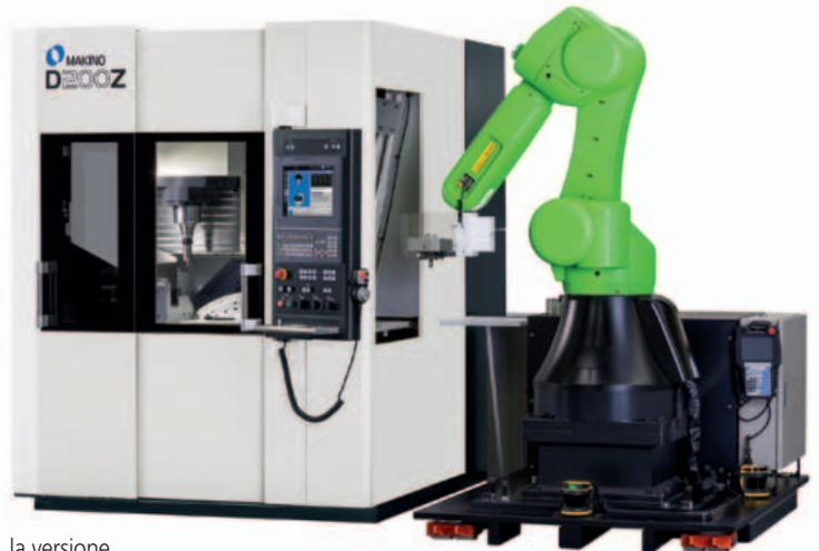
A sinistra, La D200Z con sistema pallet Microbo Mi15 e ATC100; a destra, la versione con il robot CR-35iA Fanuc.
