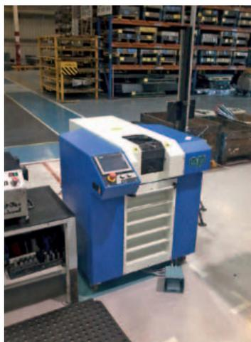
Unispeed Usfl 9037ES. La macchina ha soddisfatto le esigenze dell'azienda grazie al processo di formatura a freddo che crea una superficie piatta e liscia, con rugosità adatta a trattenere gli O-ring. La soddisfazione di CNH è dovuta anche alla semplicità di utilizzo della macchina, completamente settabile e programmabile, con possibilità di richiamo delle ricette impostate. Grazie alle diverse possibilità di regolazione la soluzione
