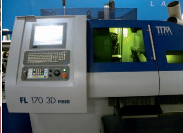
Il sistema utilizza la tecnologia laser fibra ed è fornito di testa di taglio tridimensionale.
