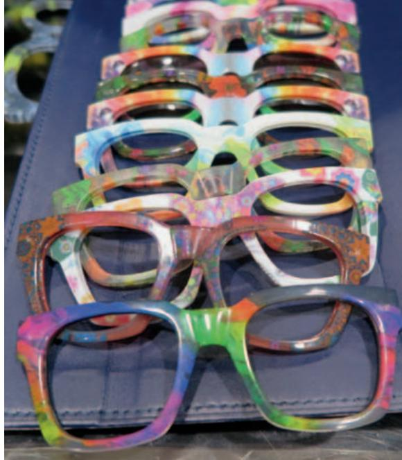
Produzione di occhiali Safilo. I prototipi sono stati realizzati con Stratasys 3D J750 full color.
