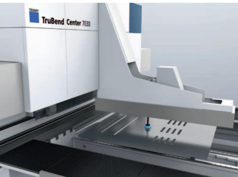
Con il nuovo manipolatore lamiera, i pezzi possono essere piegati completamente in automatico sulla TruBend Center 7030: il manipolatore blocca la lamiera e, se necessario, la ruota nella posizione desiderata.
