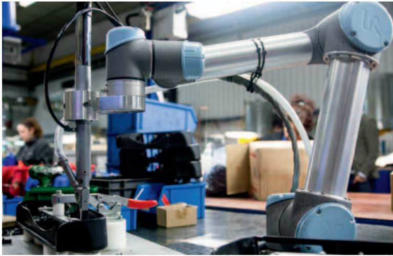
Il robot UR5 può lavorare a stretto contatto con gli operatori; alla Shad è impiegato nelle fasi di assemblaggio e avvitatura.
