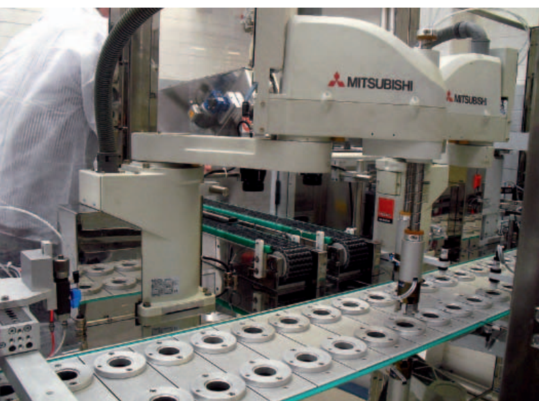
La linea produttiva di Omnicos utilizza sei robot Scara di Mitsubishi Electric.
