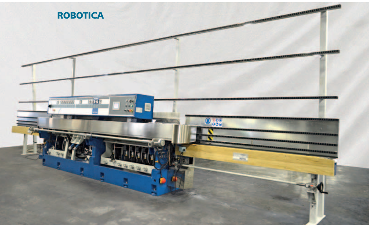
Molatrice rettilinea automatica ELB e particolare dell'impianto automatico.
