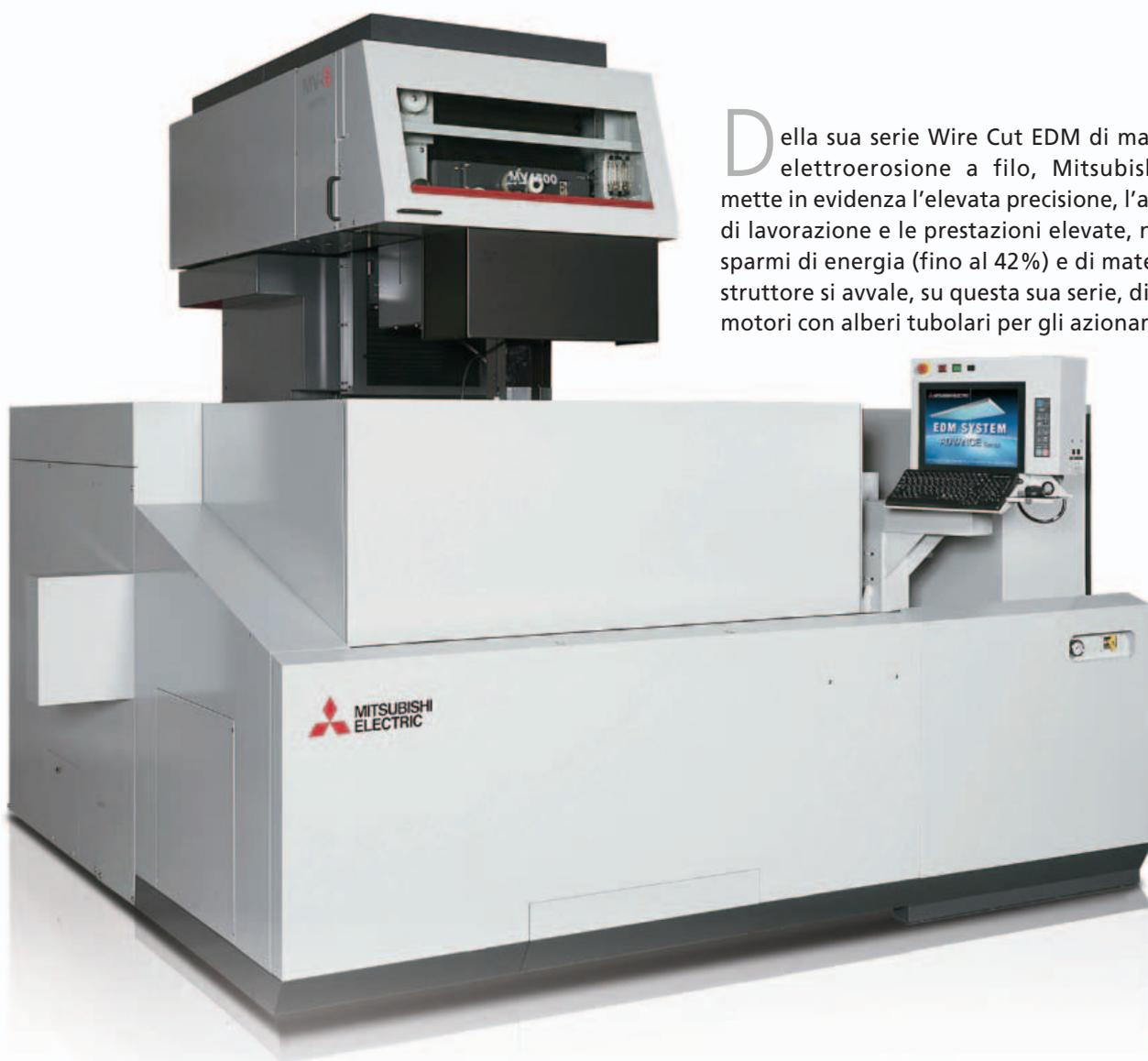
Della sua serie Wire Cut EDM di macchine per elettroerosione a filo, Mitsubishi Electric mette in evidenza l'elevata precisione, l'accuratezza di lavorazione e le prestazioni elevate, nonché i risparmi di energia (fino al 42%) e di materiali. Il costruttore si avvale, su questa sua serie, di innovativi motori con alberi tubolari per gli azionamenti degli
