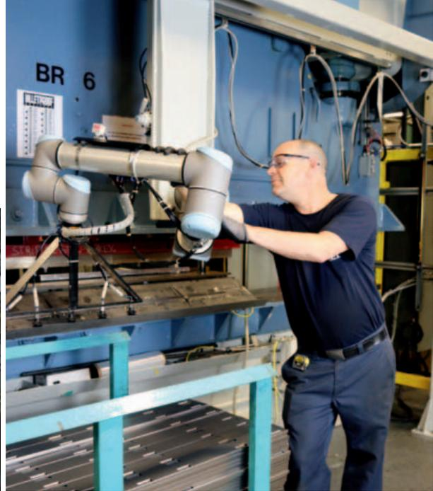
La manipolazione di un robot UR a contatto con il lavoro svolto dall'operatore, senza barriere. I robot sono in alluminio, non necessitano strutture o spazi operativi significativi per essere installati.
