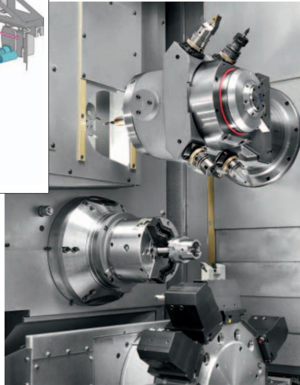
internamente. Questo consente di indicizzare la torretta su ogni posizione preferita senza necessità di un meccanismo di blocco meccanico. Il posizionamento libero della torretta rende possibile l'assegnazione di più utensili per ogni stazione.
