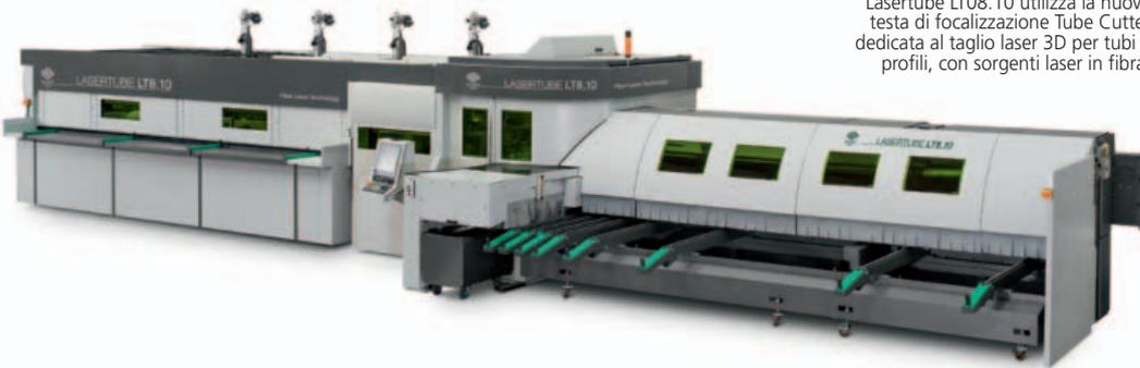
Lasertube LT08.10 utilizza la nuova testa di focalizzazione Tube Cutter dedicata al taglio laser 3D per tubi e profili, con sorgenti laser in fibra.
