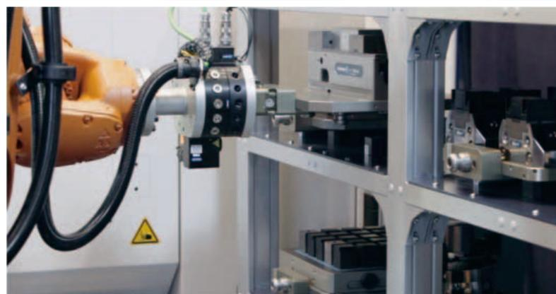
Cella dimostrativa Schunk per asservimento robotizzato alla 30 BiMu. Il cambio rapido SWS Schunk installato sul robot e la pinza magnetica EGM per lo spostamento di singoli pezzi.
