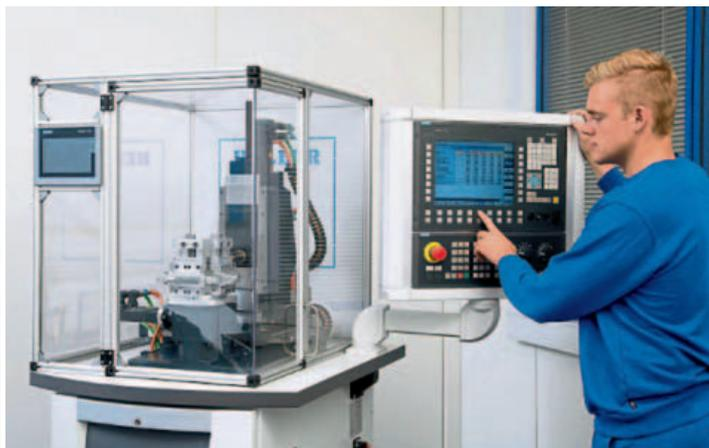
Durante la tre giorni di Nürtingen, Heller ha presentato 'ProfiTrainer', (a destra) un modello in scala ridotta di una macchina utensile a quattro assi, perfettamente funzionante: un utilissimo strumento didattico.
