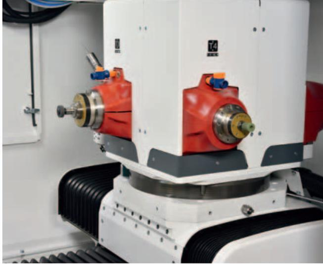
La rettificatrice cilindrica interna di raggi S141 per pezzi di grandi dimensioni e il revolver porta-mandrino a 4 attacchi (ad alta precisione) e ad azionamento diretto
