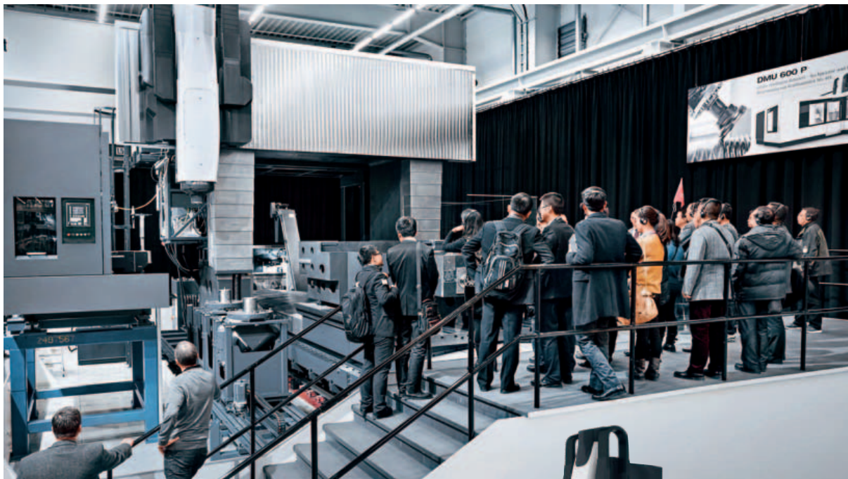
La DMU 600 G linear è dotata di un'eccellente struttura gantry. XXL Center di Deckel Maho Pfronten è specializzato nella lavorazione di pezzi di grandi dimensioni.
