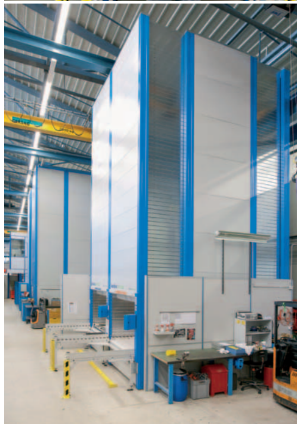
Complessivamente, alla ABB di Oerlikon vengono utilizzati 20 magazzini automatici verticali Kardex Remstar. I processi di prelievo del tool pool sono ora più efficienti grazie all'ultimo modello di magazzino verticale Shuttle XP 1000.
