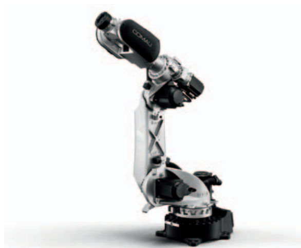
Racer999, robot antropomorfo a sei assi. Racer3: peso di 30 kg e portata al polso di 3 Kg. Il robot NJ130-2.0 con payload di 130 kg.
