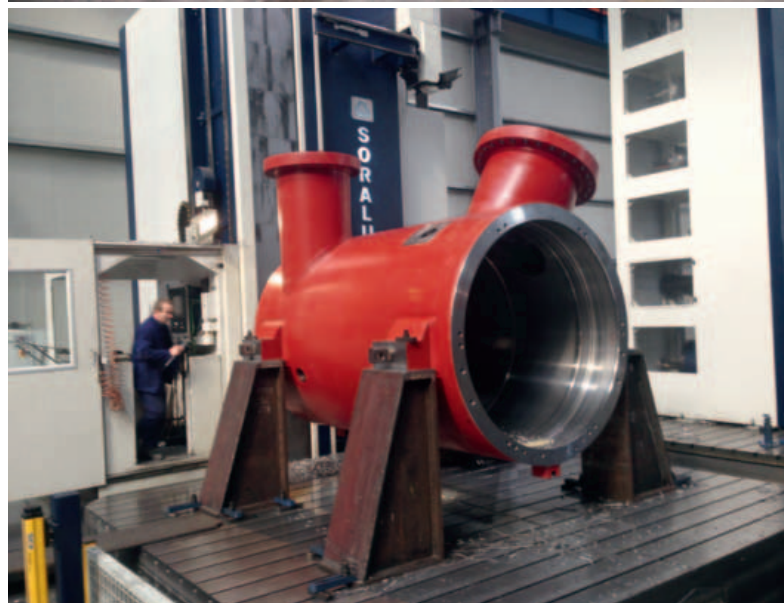
Nello stabilimento MPC, si eseguono lavorazioni di fresatura, alesatura e tornitura principalmente di pezzi molto grandi del peso di decine di tonnellate.
