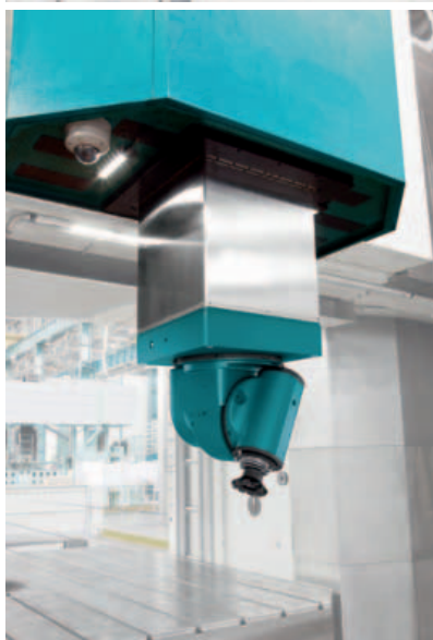
Vertiram dispone di un sistema di cambio teste su navetta, ed è in grado di applicare queste ultime in qualsiasi posizione si trovi la macchina.
