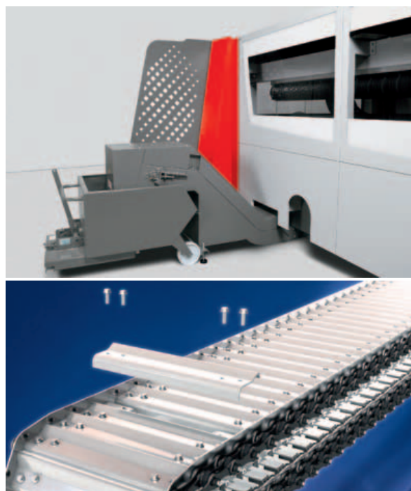
Kabelschlepp ha sviluppato per Bystronic un sistema di convogliamento che riduce i tempi di service e aumenta le prestazioni della macchina. Le tapparelle del sistema Wave-Belt sono avvitare e si possono sostituire singolarmente.
