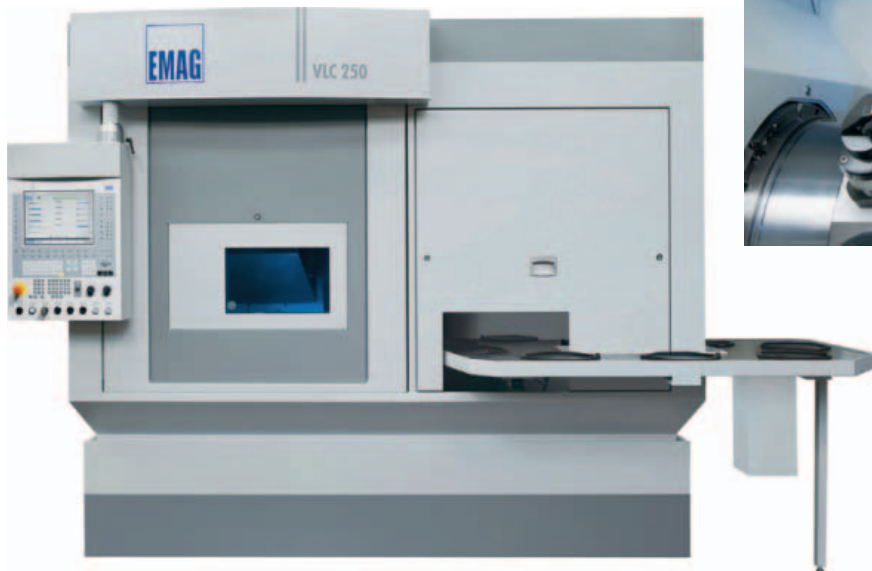
Il tornio verticale Emag VLC 250 standard può essere attrezzato con console per lavorazioni skiving.
