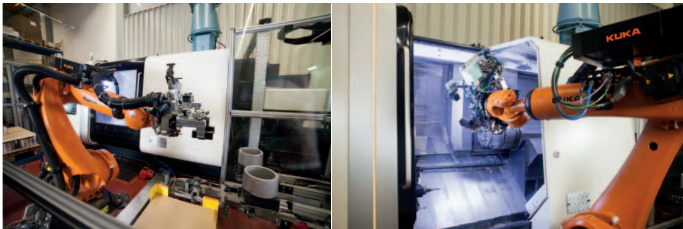
Un KR 150 R2700 extra della serie Kuka KR Quantec carica e scarica le macchine utensili.
