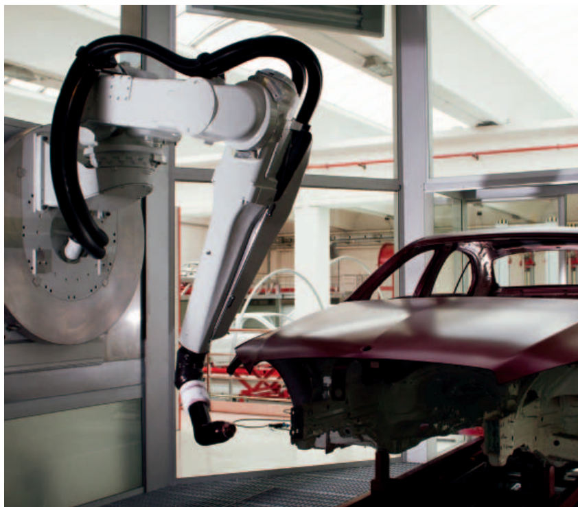
La cella J-Hive permette di migliorare la fluidità dei movimenti del robot e della scocca auto, consentendo di raggiungere perfettamente tutte le zone interne ed esterne della superficie da verniciare.
