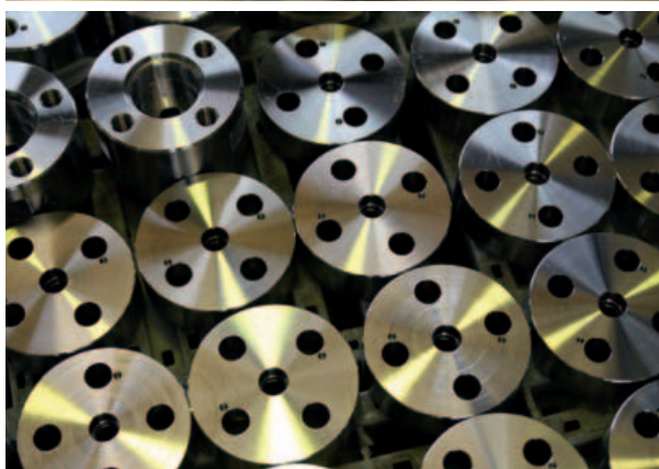
Bama applica la tecnica dell'elettrolucidatura a qualsiasi pezzo in metallo o lega metallica esistente, dal componente più grosso alla vite più minuscola.
