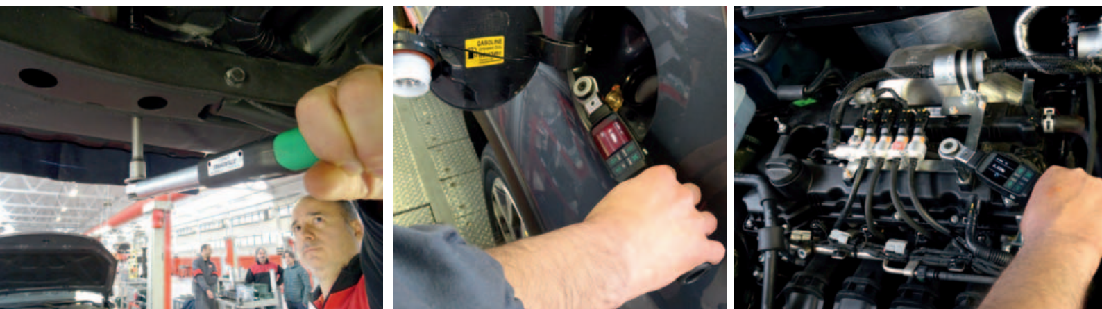
Il montaggio di una canalina di fissaggio del serbatoio toroidale 50 Nm, il fissaggio della presa carica GPL 6 Nm e il fissaggio della staffa gruppo rail iniettori GPL/Filtro GPL a gruppo motore a 8 Nm.
