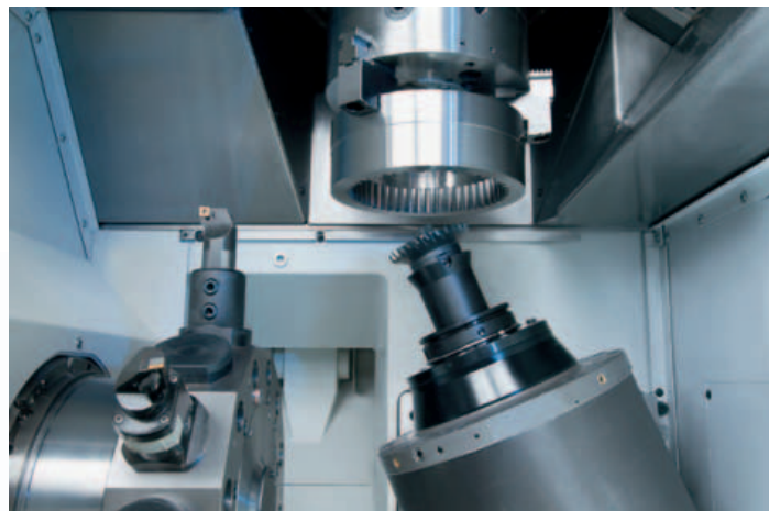
Il tornio verticale Emag VLC 250 standard può essere attrezzato con console per lavorazioni skiving.
