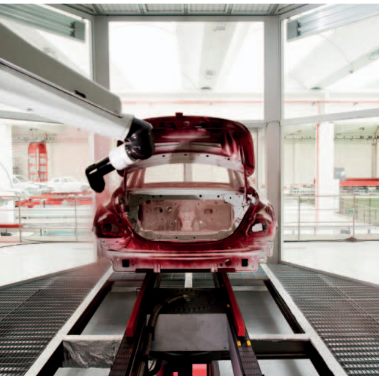
La cella J-Hive permette di migliorare la fluidità dei movimenti del robot e della scocca auto, consentendo di raggiungere perfettamente tutte le zone interne ed esterne della superficie da verniciare.
