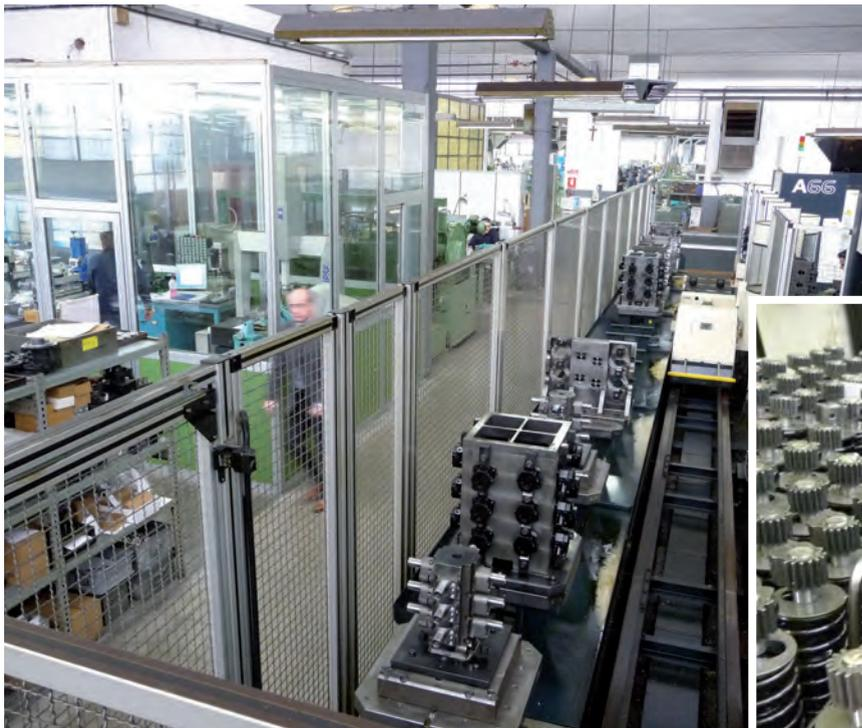
Sopra FMS Makino, a destra corpi iniettore e sotto elementi pompanti.
