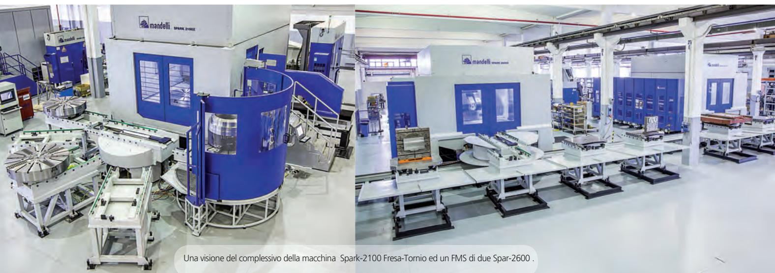
Una visione del complessivo della macchina Spark-2100 Fresa-Tornio ed un FMS di due Spar-2600 .
