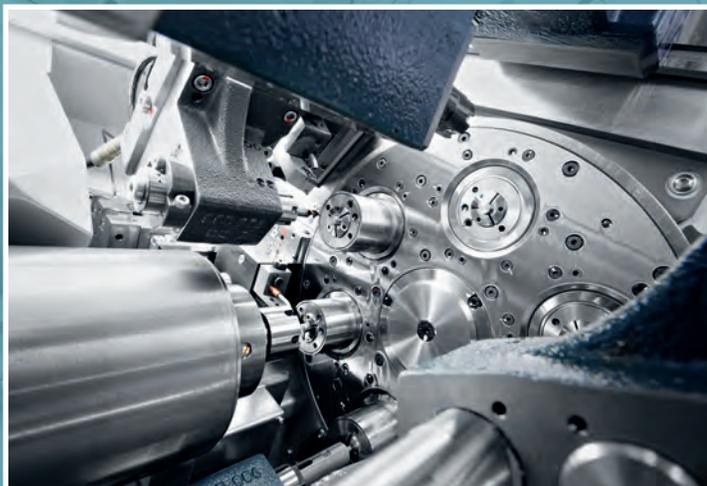
**MULTISWISS 6X 16:** grazie al bariletto motorizzato, la MultiSwiss raggiunge i ritmi di produzione delle macchine a camme in modo particolarmente silenzioso. L'accesso anteriore, le periferiche integrate, la programmazione semplificata ed accessibile rendono la MultiSwiss estremamente ergonomica e facile da avviare.
