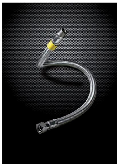
installazione in qualsiasi impianto domestico, eliminando il vincolo della sostituzione quinquennale. A differenza di prodotti analoghi, di solito interamente metallici, questo tubo all'interno è in materiale termoplastico rivestito da una treccia di acciaio inox, il che lo rende competitivo in termini di prezzo ed estremamente affidabile dal punto di vista della qualità. Con queste caratteristiche, Sicurgas NG rappresenta una valida alternativa al tradizionale tubo metallico.
