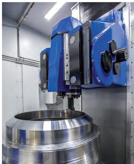
La testa di tornitura e la tavola a tornire della macchina Spark-2100 Fresa-Tornio.
