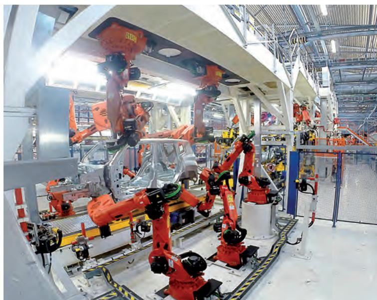
Con una storia consolidata nell'industria automobilistica, Comau diversifica le proprie competenze e impiega il proprio know-how per operare in nuovi ambiti e realizzare innovative applicazioni, offrendo sistemi e linee di saldatura e assemblaggio scocche, sistemi di lavorazione e assemblaggio motori e una vasta gamma di robot industriali per tutti i campi applicativi. L'azienda fornisce, inoltre, servizi di eco-sostenibilità e di manutenzione, destinati ad un'ampia gamma di settori industriali.
