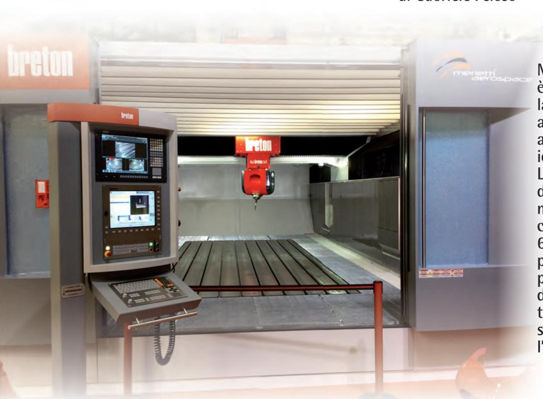
Merletti Aerospace è specializzata nella lavorazione di componenti aeronautici in acciaio ad alta resistenza, titanio, inconel e leghe leggere. L'installazione del centro di lavorazione Breton, modello Matrix a 5 assi, con corse massime 6.000 x 3.000 mm, permette la lavorazione di pezzi strutturali di grandi dimensioni. Ma non è tutto, l'azienda propone soluzioni che vanno oltre l'asportazione di truciolo
