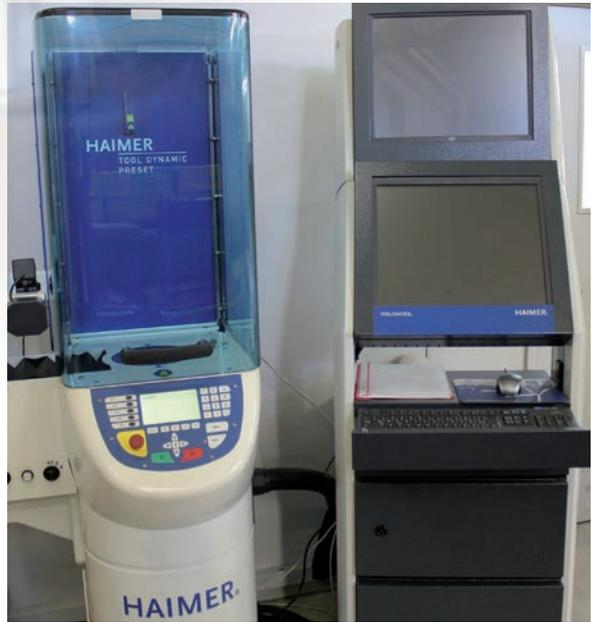
Presso le stazioni per il calettamento vi è una macchina bilanciatrice Tool Dynamic Preset, una soluzione combinata per bilanciare e per misurare sia i mandrini sia gli utensili.
