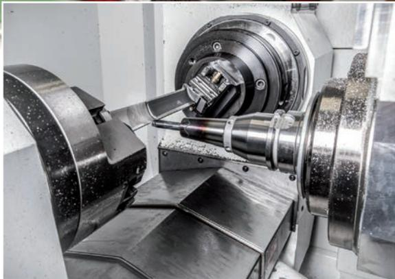
Grazie allo spessore rinforzato della parete nell'area di serraggio e grazie ad alcune caratteristiche costruttive i mandrini Heavy Duty Shrink di Haimer raggiungono elevate forze di serraggio e si adattano all'asportazione pesante con grandi utensili.
