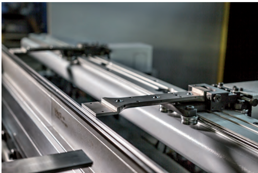
A sinistra, particolare degli utensili di pressatura Schiavi e delle testine robotizzate per il supporto della lamiera. A destra il nuovo CNC Atlas.
