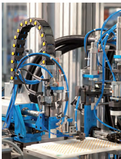
La caratteristica saliente dell'impianto sta nell'alimentare e manipolare particolari di piccole dimensioni; a destra, il gruppo alimentazione.
