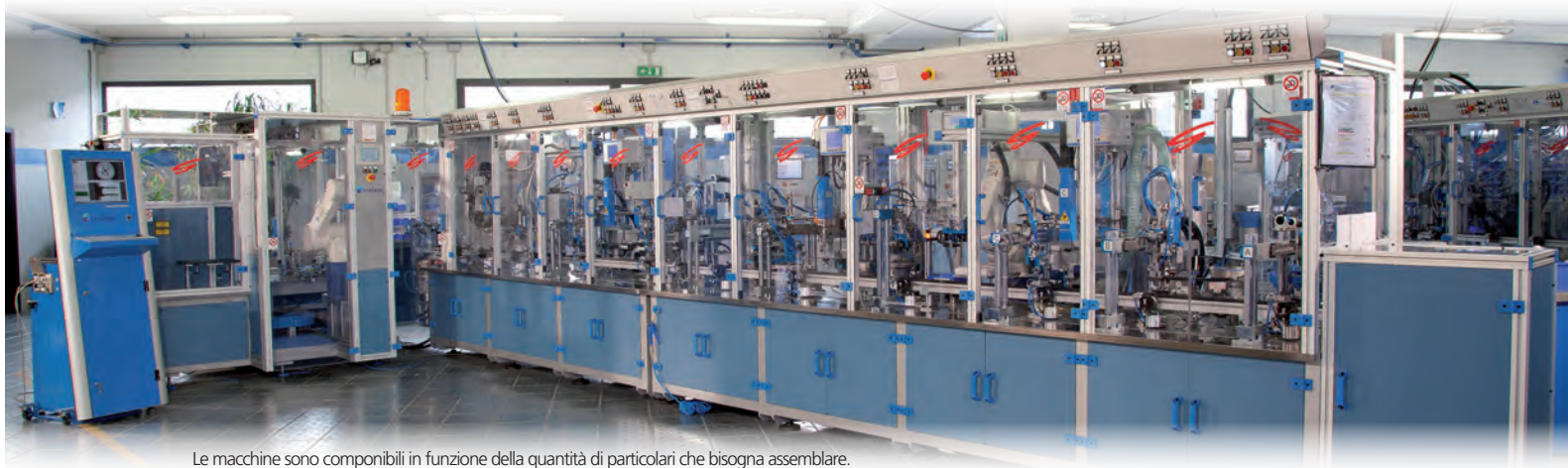
Le macchine sono componibili in funzione della quantità di particolari che bisogna assemblare.
