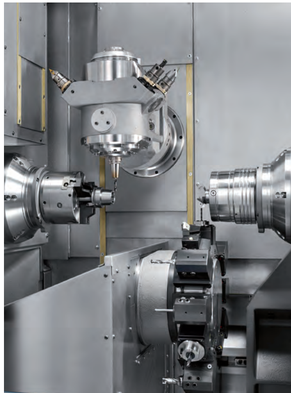
Grazie all'ampia area di lavoro e alla distanza tra mandrino principale e contro-mandrino, è possibile la lavorazione simultanea con il mandrino portafresa motorizzato e la torretta utensili al mandrino principale e al contro-mandrino.
