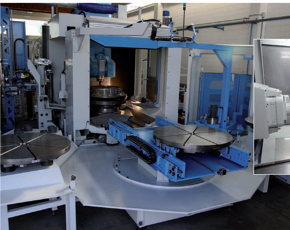
Una veduta di i.Tank Multitasking Multipallet con testa tilting e un particolare del gruppo divisore per tornitura orizzontale.
