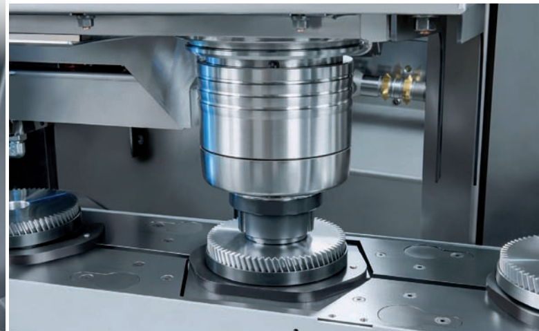
Sulla smussatrice verticale pick-up VLC 100 C si vede la tecnologia Chamfer-CUT. Il carico e lo scarico avvengono tramite mandrino di lavorazione pick-up.
