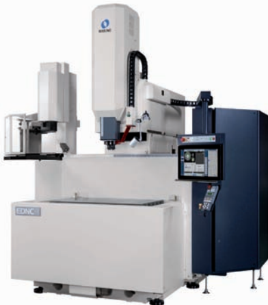
La macchina a elettroerosione a tuffo EDNC6/8 estremamente precisa soprattutto nell'asse Z.
