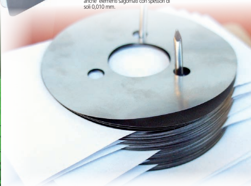
Il taglio con il laser e la tranciatura di lamiera e fogli molto sottili sono i punti di forza di Martin. Si realizzano vari pezzi e anche elementi sagomati con spessori di soli 0,010 mm.
