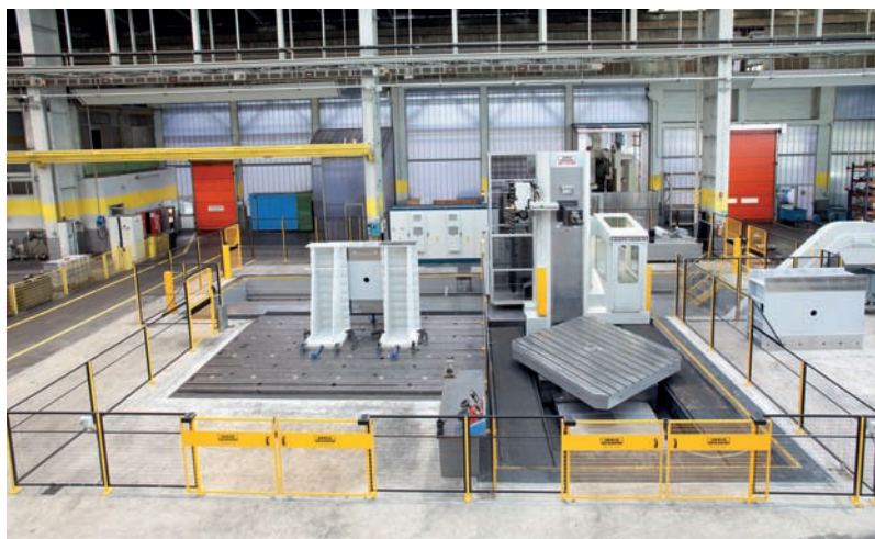
Per lavorazioni di alluminio, invar, strutture in elettrosaldato, alluminio Innse Berardi propone la Zenith Vision M. La testa universale meccanica TU-45 3+2 assi e la testa a forcella con elettromandrino TOM-E45.
