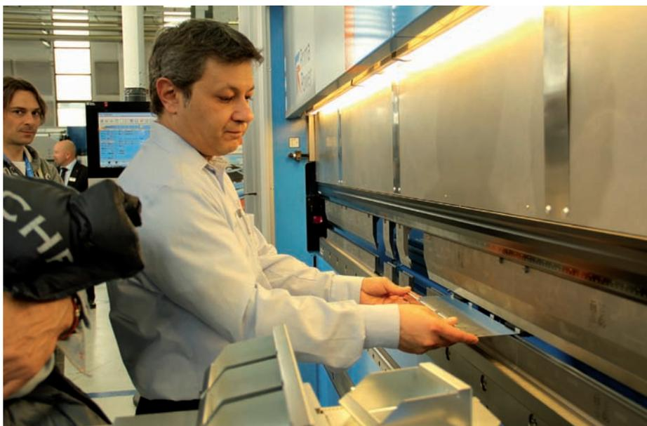
Sopra, una dimostrazione presso la piegatrice elettrica Ep; sotto, il sistema PunchBend Prima Power.
