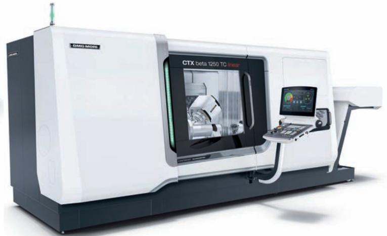
netto maggiorato dell'asse B e a una testa portafresa pensata ad hoc per l'applicazione pratica, con il 20% di stabilità in più. La combinazione tra campo di brandeggio esteso, un profilo di interferenza migliorato a fronte di una maggiore sporgenza e una catena portacavi integrata nell'alloggiamento, garantiscono uno spettro di applicazioni ancora più vario.
