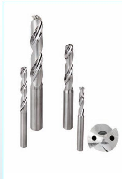
taglio per un'eccezionale durata dell'utensile. Evacuazione truciolo e riduzione delle forze di taglio sono migliorate anche dal design delle eliche a spirale, e sono disponibili diametri da 3,0 a 20 mm e lunghezze da 3xD e 5xD (con refrigerante interno), oltre a dimensioni in pollici, metriche, frazionarie e di pre-fori di maschiatura.
