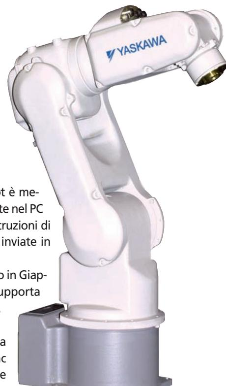
La mansione del robot è memorizzata direttamente nel PC o nel PLC. Da qui le istruzioni di movimento vengono inviate in tempo reale al robot.
