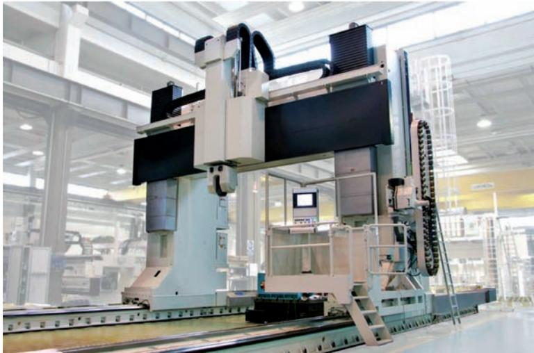
Nelle fresatrici a portale mobile JomaX 265, sono stati utilizzati riduttori Redex nel comando degli assi lineari e nella catena cinematica del mandrino.
