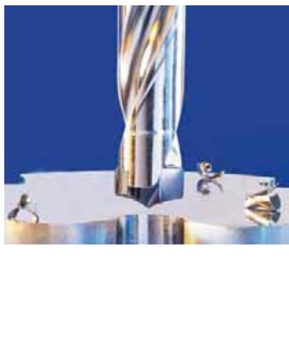
*Il margine posteriore secondario delle cuspidi Sumocham ICP/K 2M assicura un effetto raschiante.*
