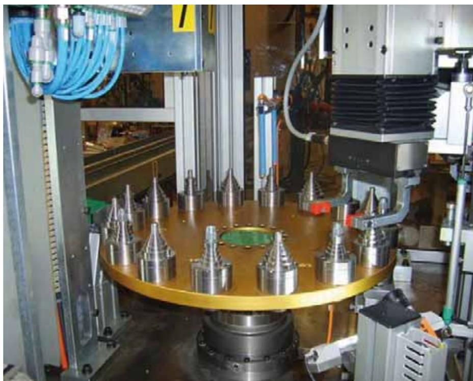
*Il cuore della macchina è costituito da una tavola rotante collegata con un riduttore di precisione a un servomotore Lenze MCS, dotato di encoder assoluto multigiro e azionato mediante servo drive della serie i700/ECS.*
