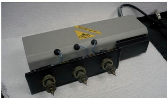
L'ultima generazione Couth di macchine marcatrici per punti è la serie MC 2000 Superfast. Può operare su ogni tipo di materiale (metalli, plastica, legno ecc.) e forme (piane, curve, interne ecc.).
