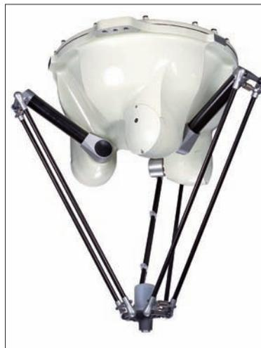
*Il manipolatore ad alta velocità Kawasaki YF003N (nelle foto) riconosce i prodotti e li inserisce all'interno del cartone/vassoio secondo lo schema richiesto.*
