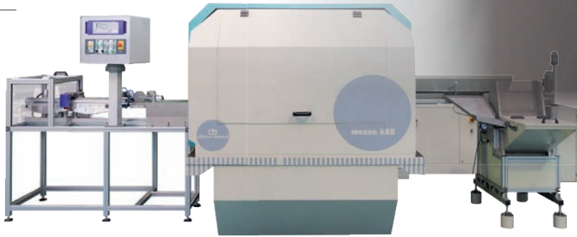
Rettificatrice senza centri modello Monza 620/350 CNC2 con sistema di misurazione laser.
