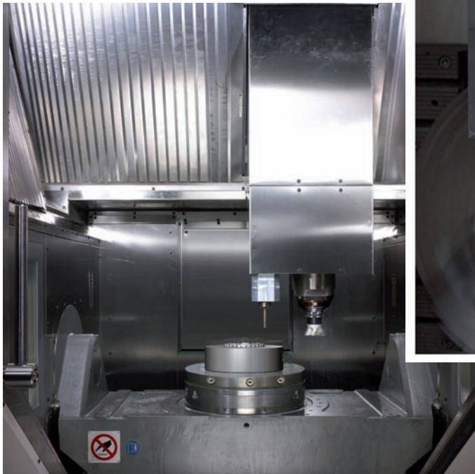
La Hermle va un passo avanti nell'ibridazione delle lavorazioni e integra il procedimento generativo MPA in un centro di lavorazione a 5 assi.
