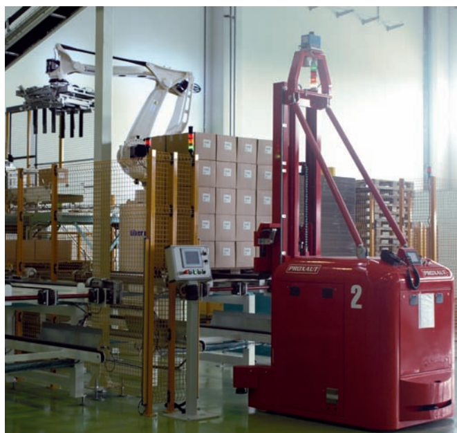
Robot Comau Smart Pal, integrato da TiberPack, in fase di palettizzazione. Al termine della palettizzazione una navetta automatica trasporta il pallet allo stoccaggio in magazzini.
