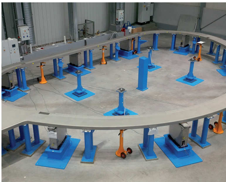
I radial plate sono componenti destinati a contenere e sorreggere il cuore di un reattore, la camera di fusione. Qui una fase di realizzazione e di trasporto.
