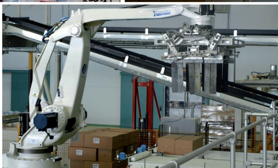
Bartolo Aprea è direttore Operations del Pastificio Ghigi. Due fasi del Robot Comau Smart Pal: in fase di movimento dopo il rilascio delle scatole e in attesa di un nuovo ciclo di lavoro.
