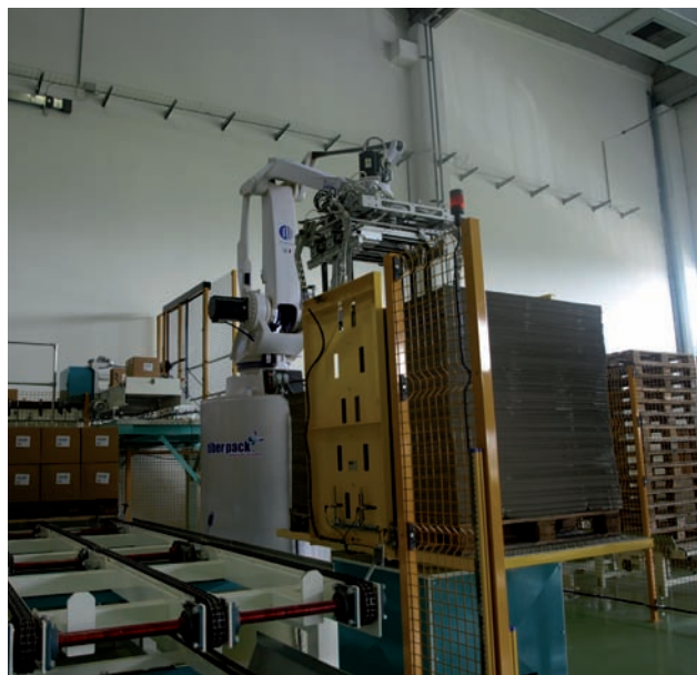
Robot Comau Smart Pal, integrato da TiberPack, in fase di palettizzazione. Al termine della palettizzazione una navetta automatica trasporta il pallet allo stoccaggio in magazzini.
