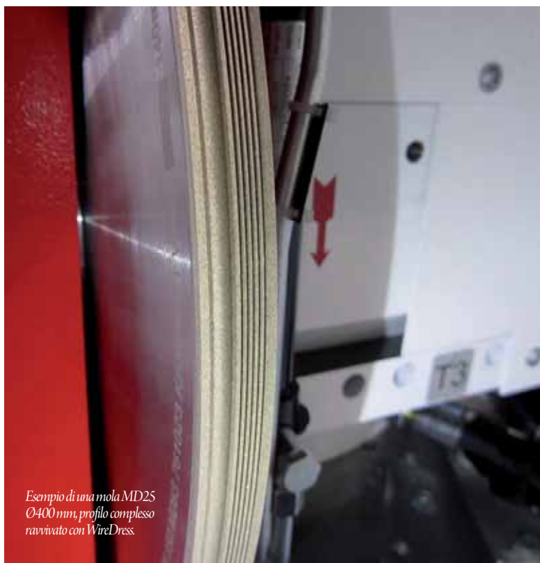
Sopra, la tecnologia WireDress permette di lavorare geometrie libere e contorni finemente strutturati; sotto, sporgenza dei grani D126 dopo la rattivatura con Studer WireDress.
