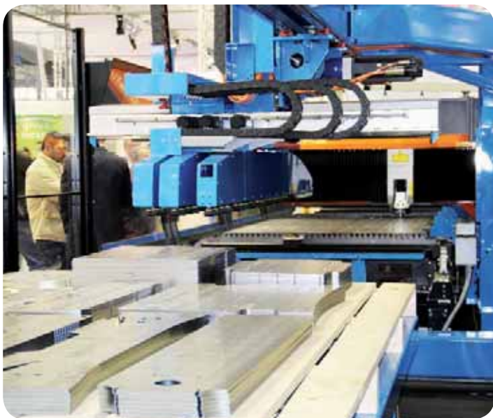
A sinistra, LST, sistema per l'impilamento automatico delle lamiere; a destra, Shear Genius: sistema per punzonatura e cesoiatura integrata con carico e uscita automatica dei componenti.
