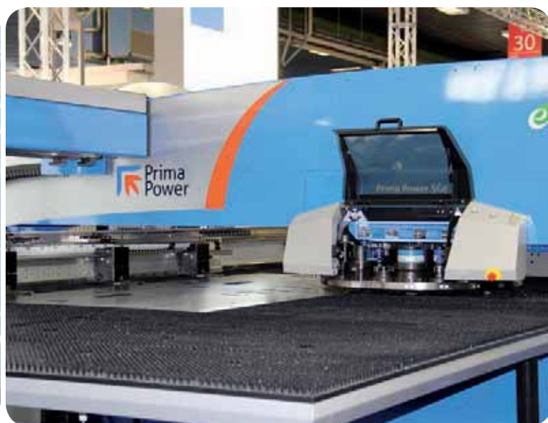
A sinistra, LST, sistema per l'impilamento automatico delle lamiere; a destra, Shear Genius: sistema per punzonatura e cesoiatura integrata con carico e uscita automatica dei componenti.
