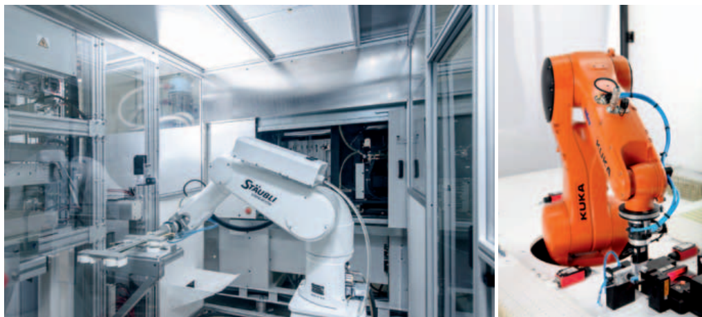
Esempio di produzione di parti in plastica per prodotti medicali (Fonte: Staubli Tec-Systems GmbH Robotics) e assemblaggio e incollaggio di componenti di plastica (Fonte: Kuka Roboter GmbH).
