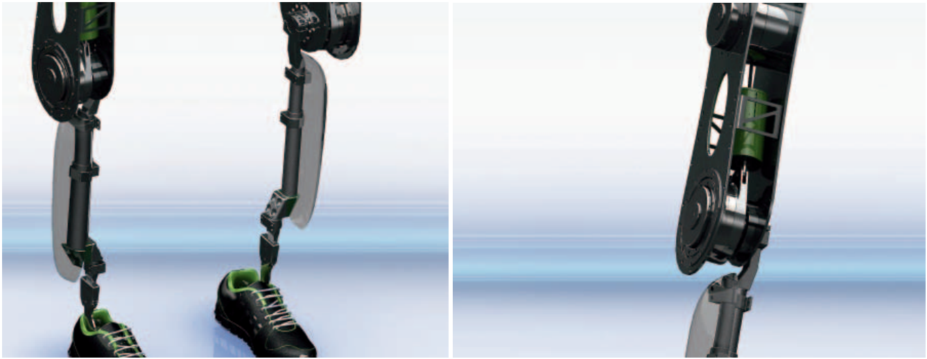
All'interno dell'esoscheletro VariLeg sono alloggiati due cuscinetti a sezione sottile di Kaydon, uno in ciascuna articolazione del ginocchio.
