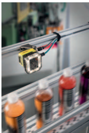
Movimentazione robotizzata di bottiglie per bevande (Fonte: Yaskawa Europe GmbH) e ispezione ottica durante la produzione di bevande (Fonte: Cognex Germany).
