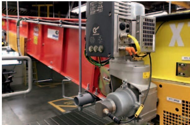
Gli azionamenti vettoriali a c.a. integrano un'interfaccia Industrial Ethernet che permette il controllo remoto dell'applicazione.
