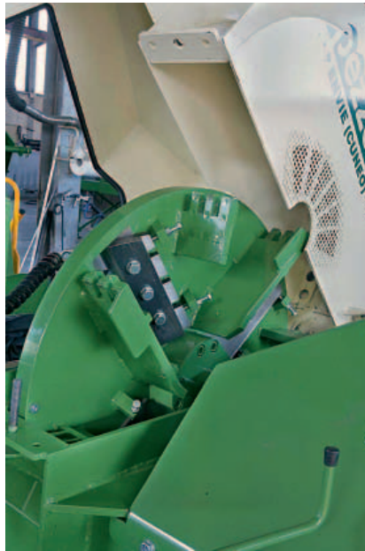
Organo sminuzzatore a disco. Il componente raggiunge velocità di 550 giri/min.
