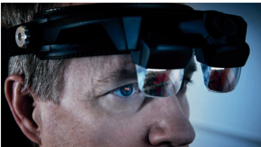
Remote Service Rexroth: grazie a particolari occhiali a realtà aumentata i tecnici Bosch Rexroth guidano il manutentore senza essere fisicamente sul campo, per aiutarlo a svolgere attività di primo intervento.
