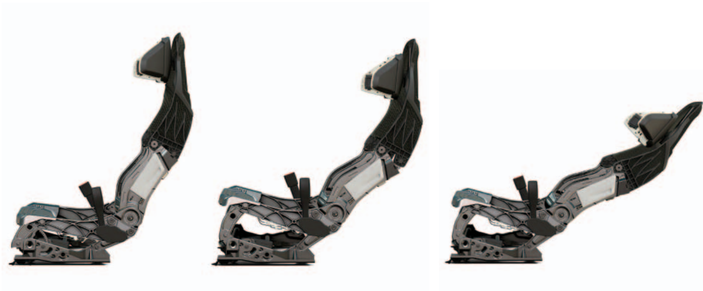
Il prototipo di sedile di guida ZF e Faurecia può assumere la posizione di guida, una posizione relax e una posizione 'di lavoro'.
