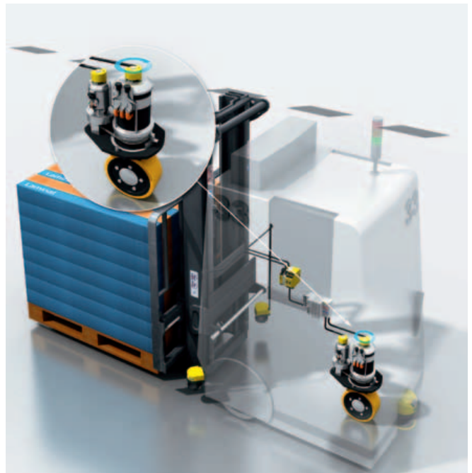
Con un solo encoder di sicurezza è possibile gestire l'AGV, anche con direzioni complesse.
