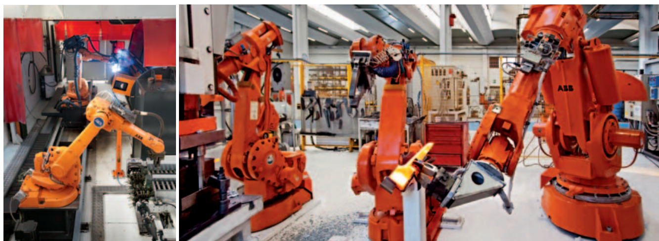
Maschio Gaspardo ha introdotto i primi robot negli anni Novanta per standardizzare il processo di saldatura mantenendo costante il livello qualitativo.
