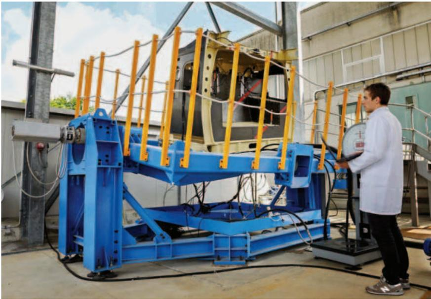
Sistema di prova e simulazione per la distribuzione del carburante (elicotteri).
