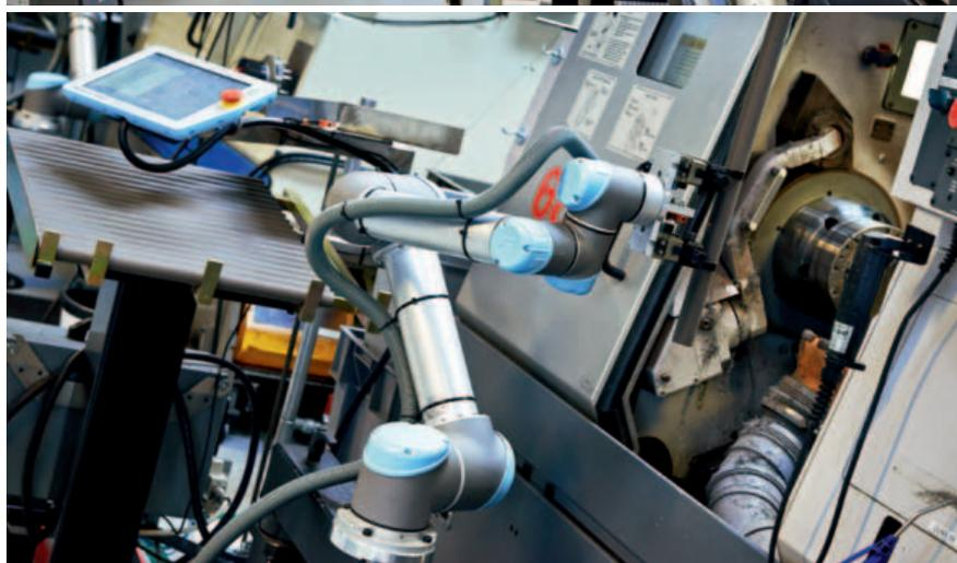
Gli operatori Trelleborg possono facilmente riassegnare i compiti a robot e pinza per produrre oggetti diversi su lotti di dimensione diversa. La programmazione è intuitiva e avviene attraverso l'interfaccia touch connessa al robot.
