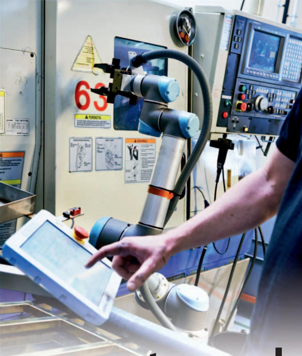
Per l'asservimento di quarantadue macchine utensili dedicate alla produzione di guarnizioni in plastica di alto profilo tecnologico, Trelleborg ha optato per le soluzioni Universal Robots. I robot prescelti sono flessibili, di piccole dimensioni e non necessitano di barriere protettive
