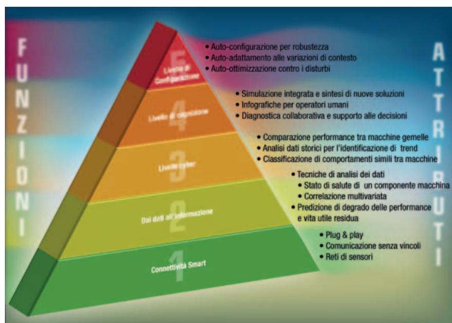
Schema a 5 livelli per l'implementazione dei cyber-physical systems in ottica I4.0.
