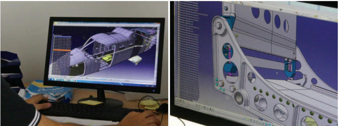
I software di progettazione utilizzati in Tecnam sono prevalentemente quelli destinati al disegno Catia 3D e bidimensionale.
