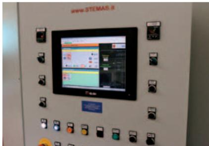
Monitor 15" Osai che fa da interfaccia sia per il PC (Nise3140) sia per il CNC (Open-XL).
