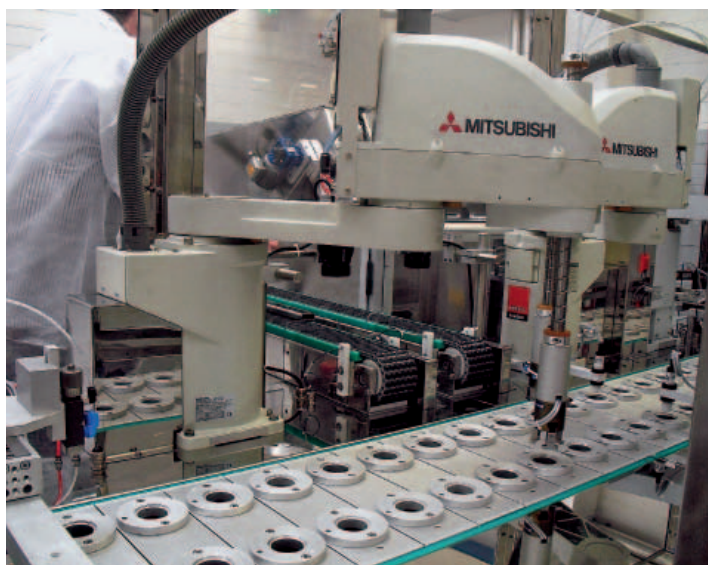
La linea produttiva di Omnicos utilizza sei robot Scara di Mitsubishi Electric.
