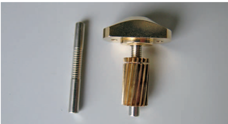
La taratura del sismografo viene effettuata attraverso una vite filettata avente un diametro di 4 mm, fornita da Eichenberger.
