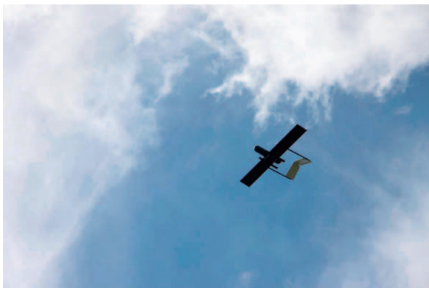
Prospero, il primo prototipo di velivolo con ali ricoperte di grafene.
