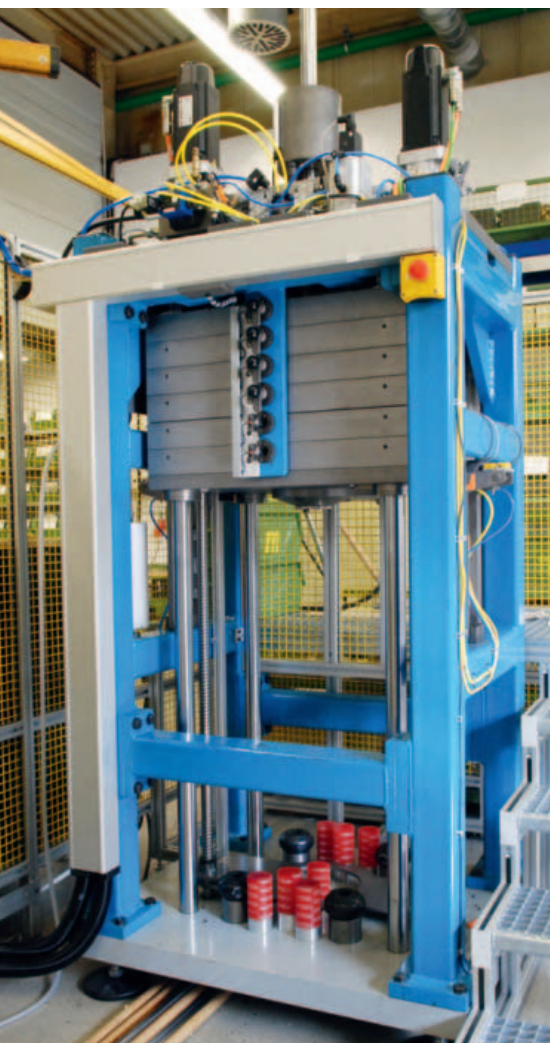
Il freno di sicurezza a comando pneumatico Roba-linearstop. Un banco di prova del costruttore DMP Sondermaschinenbau GmbH in cui è installato il freno di sicurezza lineare Roba-linearstop.
