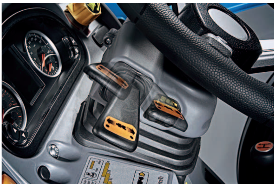
L'esclusivo inversore elettroidraulico a gestione elettronica EasyDrive, di BCS.
