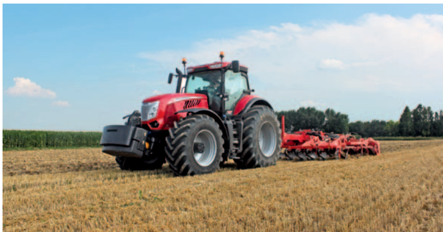
Punto di forza della serie X8, marchio McCormick, è la trasmissione a variazione continua a quattro stadi.
