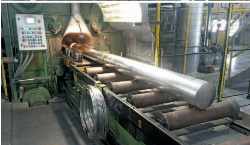
Delle barre trafilate e una pressa di estrusione inversa da 5.500 t.
