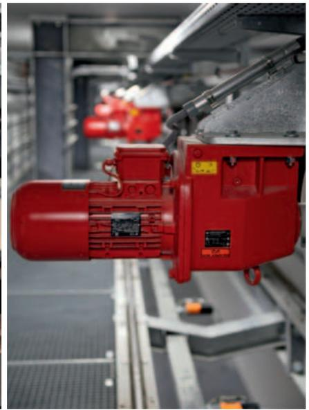
A sinistra, i motori a rotazione lenta nell'area dei passeggeri sono raffreddati da un ventilatore esterno; a destra, interruttori a prossimità e motori freno Nord con monitoraggio del traferro assicurano la distanza di sicurezza reciproca fra le cabine nel ricovero di Ischgl.
