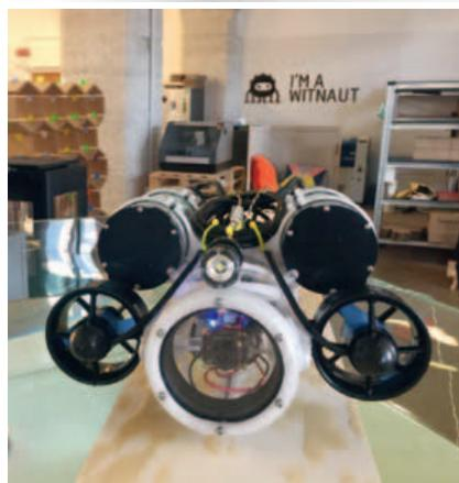
Rendering del drone eseguito con Solidworks; il peso è di circa 6 kg ed è trasportabile in uno zaino.
