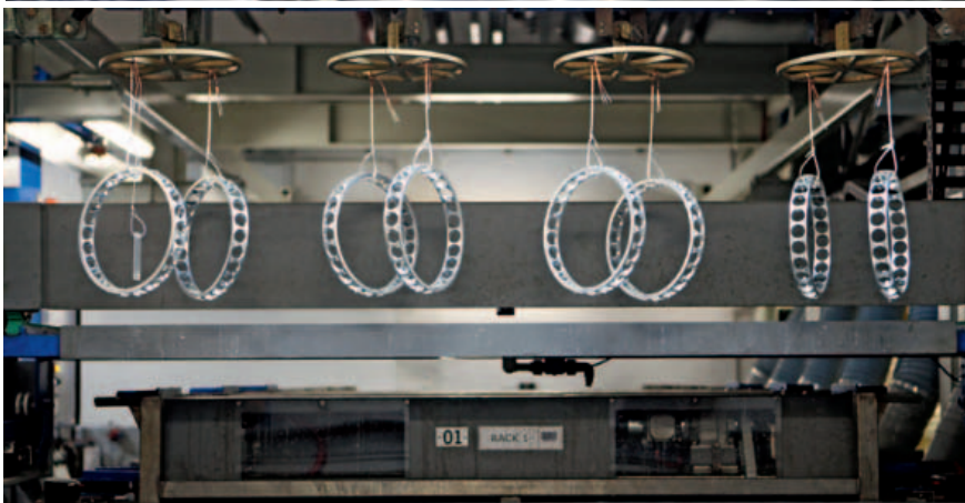
Il collaudo e la rettifica di anelli di grandi dimensioni, il sistema automatico di argentatura delle gabbie.
