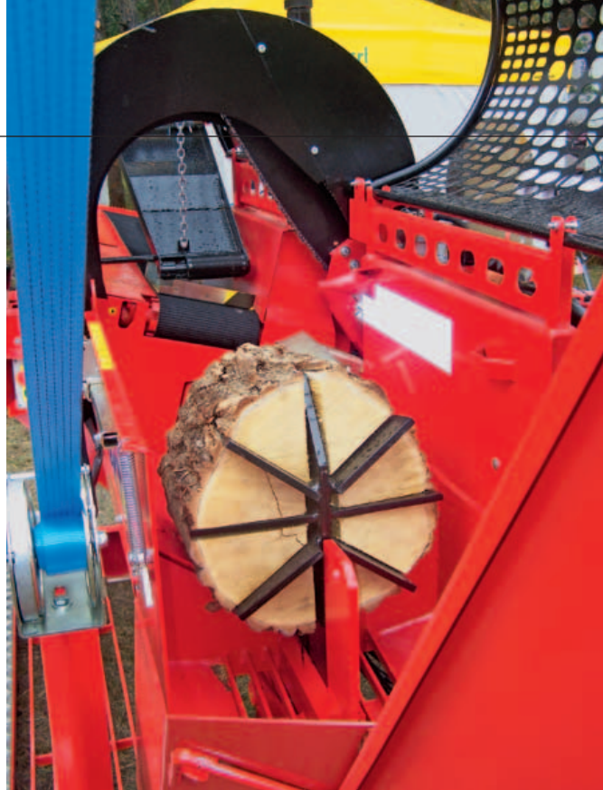
La componentistica dello spaccalegna è generalmente un cono di acciaio fissato all'estremità dello stelo di un cilindro oleodinamico, da una pompa idraulica e un distributore manuale.
