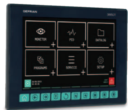
I modelli 2850T e 3850T sono controllori PID universali multiloop con schermo tattile a colori, da 3,5 e 7 pollici.
