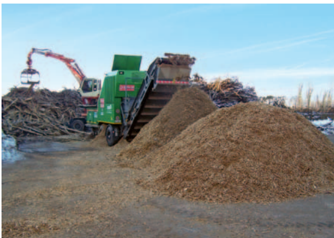
Una fase di lavorazione del legname, trasformato in biocombustibile, costituito da scaglie di legno (chip).
