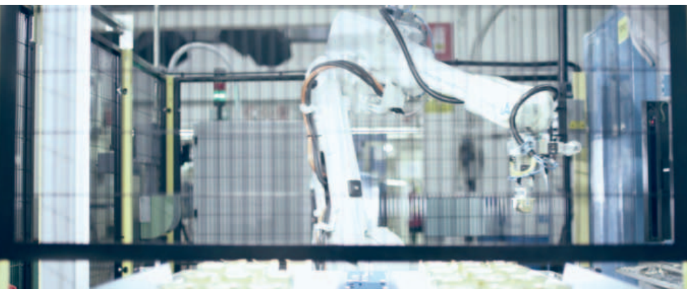
Una gamma completa di elettrovalvole per tutti i fluidi liquidi e gassosi; l'asservimento robotizzato della macchina utensile per la produzione di corpi valvola.
