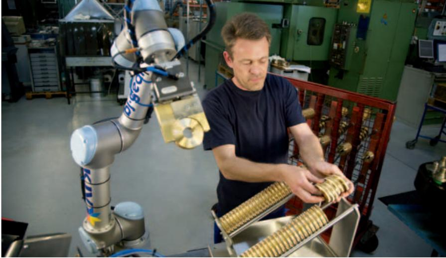
La manipolazione di un robot UR a contatto con il lavoro svolto dall'operatore, senza barriere. I robot sono in alluminio, non necessitano strutture o spazi operativi significativi per essere installati.
