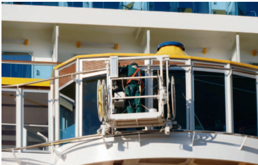
Anche le macchine per il lavaggio delle finestre costruite da Navalimpianti sono azionate da motoriduttori.
