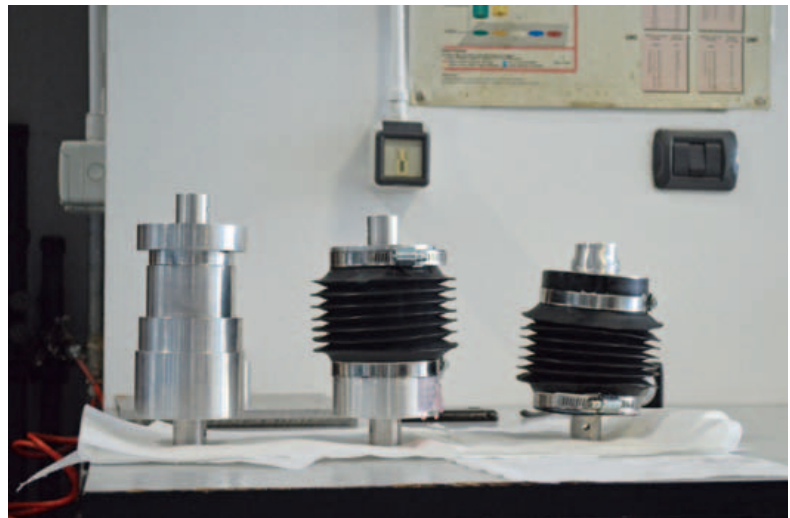
Una fase della produzione di prototipi della linea RA-27.C (anno 2012) e il confronto tra prototipi pre/post-crash rispetto a un componente in assemblaggio.
