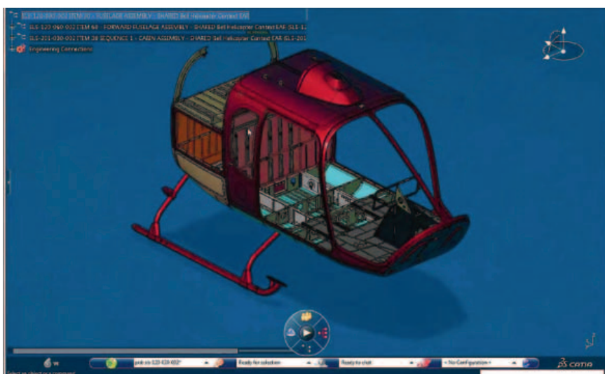
Assieme della fusoliera disegnato con Catia V6.
