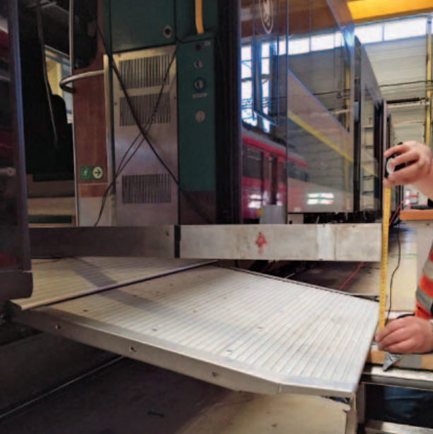
La rampa montata sul treno Emu72 delle ferrovie norvegesi NSB. Applicazione R+W tra motoriduttore e vite della frizione, realizzata da Tekontracks.
