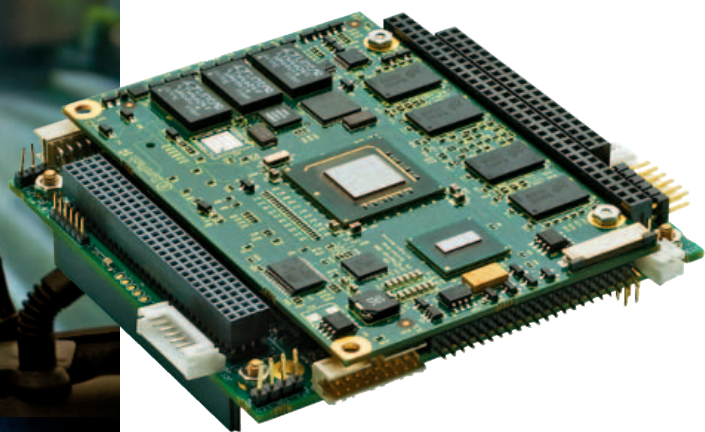
Eurotech ha sviluppato il single board computer Isis, che costituisce un elemento centrale per il controllo dei sistemi avanzati di assistenza al pilota (Aras- Advanced rider assistance systems).
