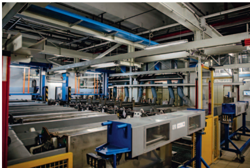
Fase di argentatura delle gabbie dei cuscinetti e impianto produttivo.
