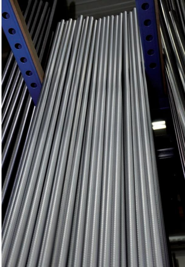
Viti filettate tipo Speedy con diametro da 26 mm e passo 6 mm.
