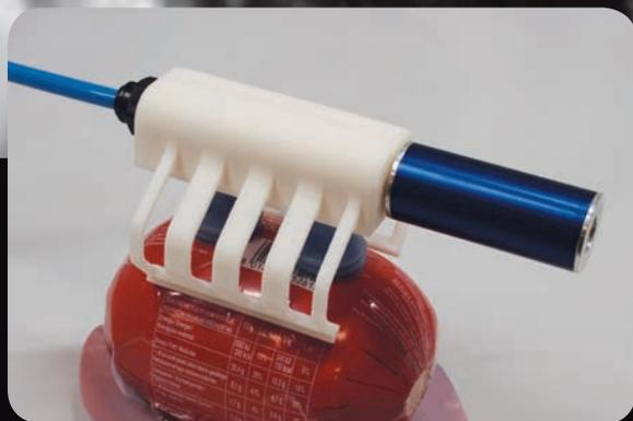
Nuove teste di presa Octopus realizzate in ABS con tecnologia 3D Printing.
